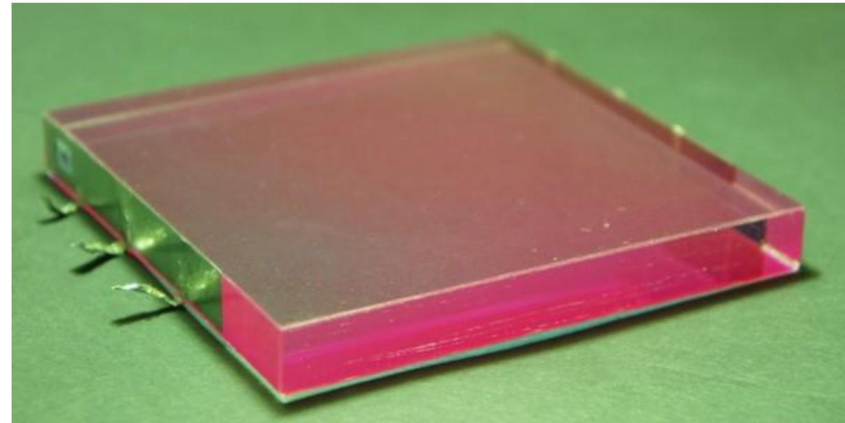
Прямой солнечный свет, попадающий на верхний слой концентратора, имеет определённое выделенное направление. Однако лучи света, переизлучённого верхним слоем концентратора после поглощения солнечного, имеют уже разные направления. То есть количество света, испущенного в разных направлениях, примерно одинаково.
