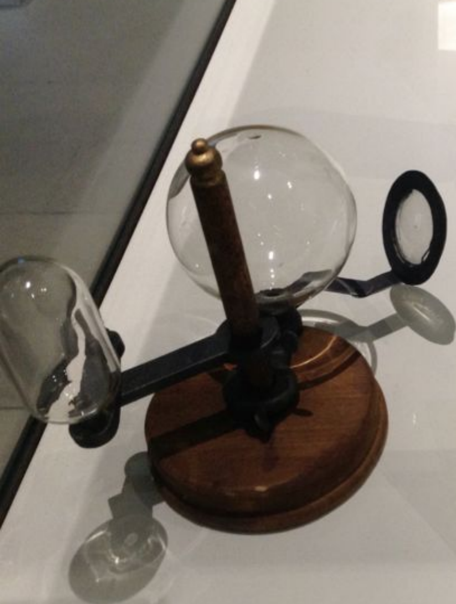
Микроскоп Р.Гука (1665 г.) Модель Р.Гук усовершенствовал микроскоп Дреббеля, введя в него третью линзу - коллектив, - что делало изображение более отчетливым. Микроскоп Гука отличался от своих предшественников и более удачной механической конструкцией.
