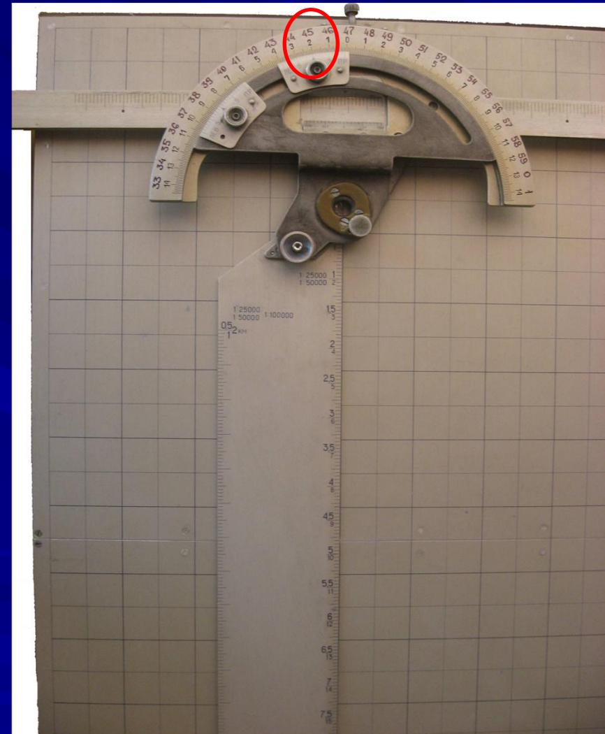
В зависимости от масштаба и направления возрастания координат производят оцифровку шкал линеек координатора (для масштаба 1:25 000 через одно большое деление).
