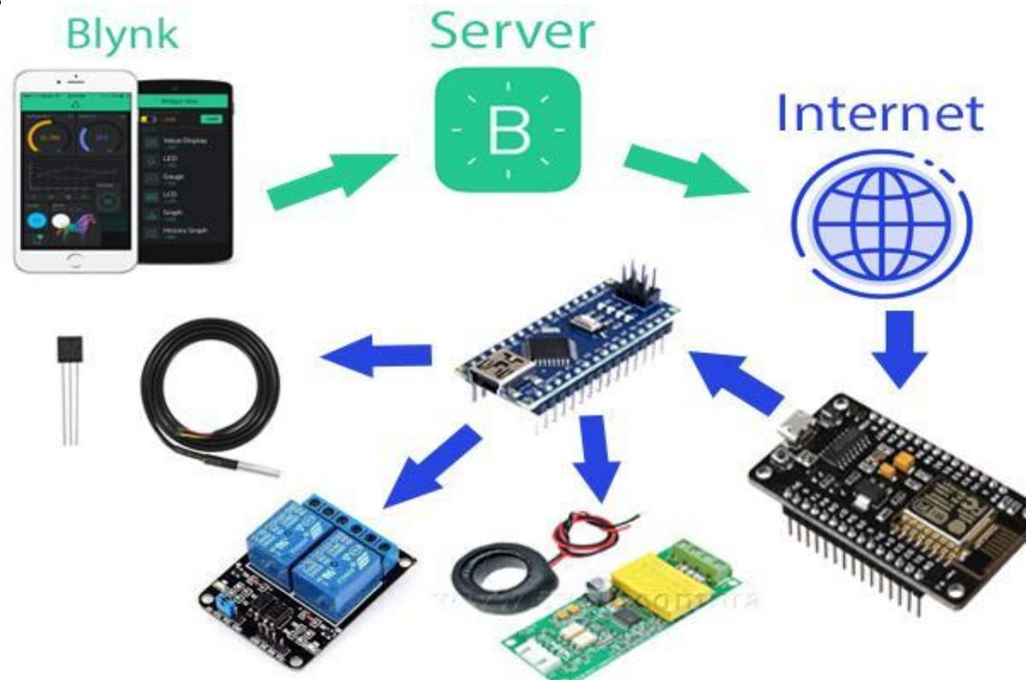
Структурная схема управления с приложения через сервер Blynk на ESP подаем команды и запрашиваем данные собранные с датчиков температуры и энергии и обработанные Arduino. Вид приложения Blynk в наших тестах. Кнопки, показания датчиков, графики.
