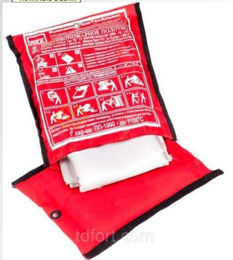
**Покрывало пожарное (кошма)** Способ использования этих первичных средств пожаротушения прост, просто накрываем пламя, которое без доступа кислорода содержащегося в воздухе исчезает. Следует помнить, что потушить очаг возгорания, который больше размера покрывала не получится. Покрывала предназначены для изоляции очага горения от доступа кислорода и применяются лишь при небольшом очаге горения.
