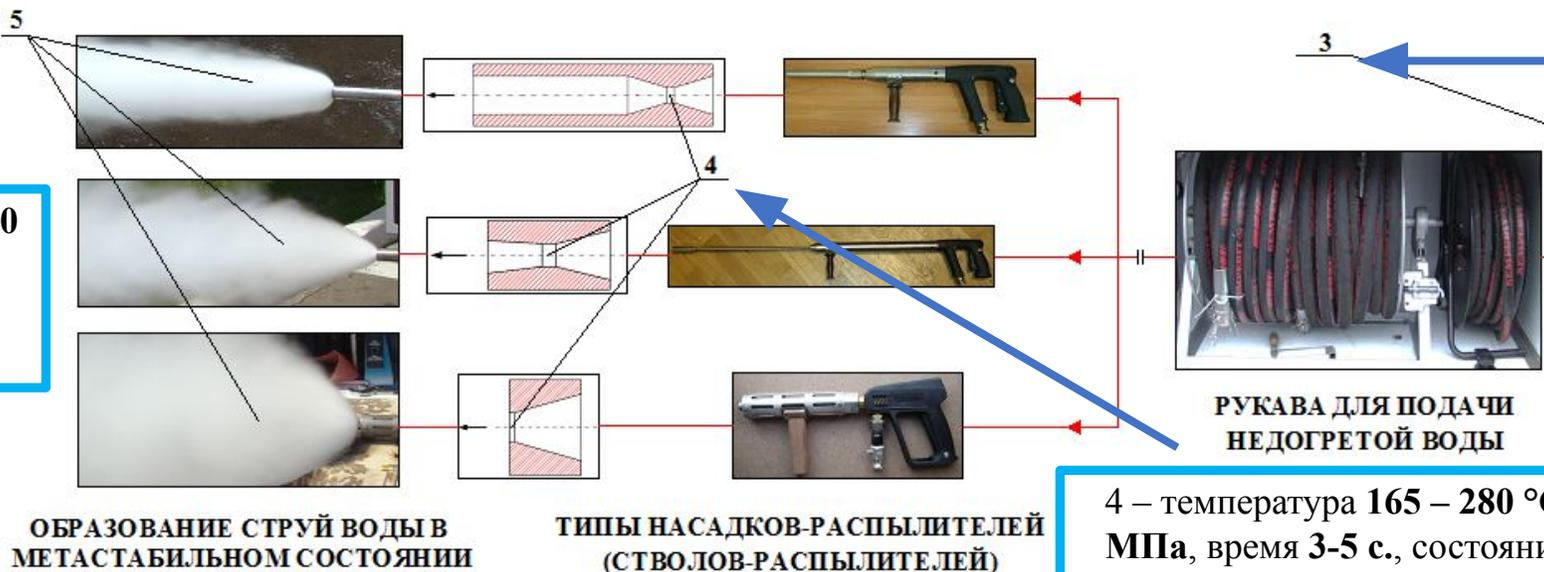
4 – температура 165 – 280 °С, давление 0,6-1,9 МПа, время 3-5 с., состояние перегретая вода
