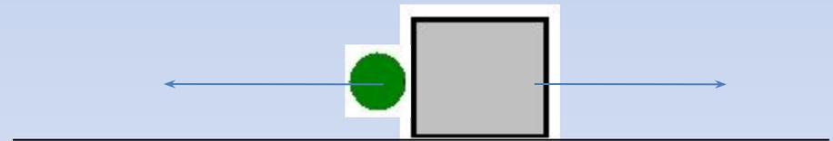
При стрельбе из орудия возникает **отдача** – снаряд движется вперед, а орудие – откатывается назад. Снаряд и орудие – два взаимодействующих тела. Скорость, которую приобретает орудие при отдаче, зависит только от скорости снаряда и отношения масс
