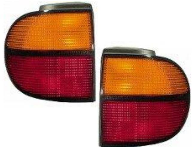
**Установка комбинированных фонарей позволяет осуществить отдельную схему световой сигнализации, при которой сигналы поворота и сигналы торможения подаются различными источниками света (лампами) и различными рассеивателями, установленными в каждом корпусе задних фонарей.**
