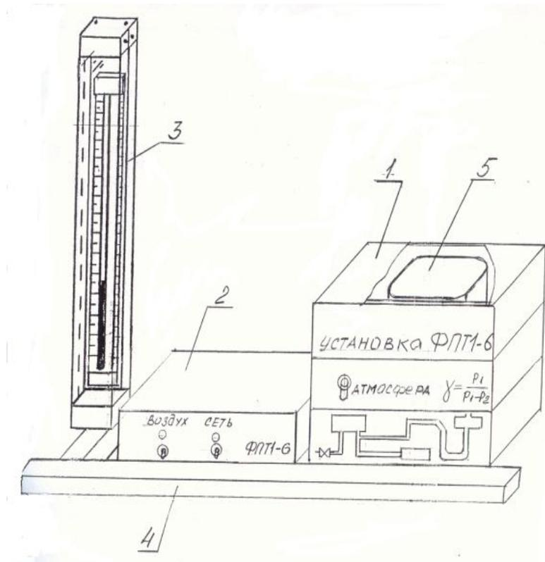
1-2. блок приборный БП-6, 3. блок манометра. 4. стойка, 5. стеклянная колба.
