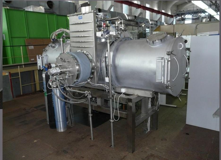
*Проведение автономных испытаний катодов с расходом рабочего тела до 1 мг/с. Основные испытываемые изделия: различные модификации катодов.*
