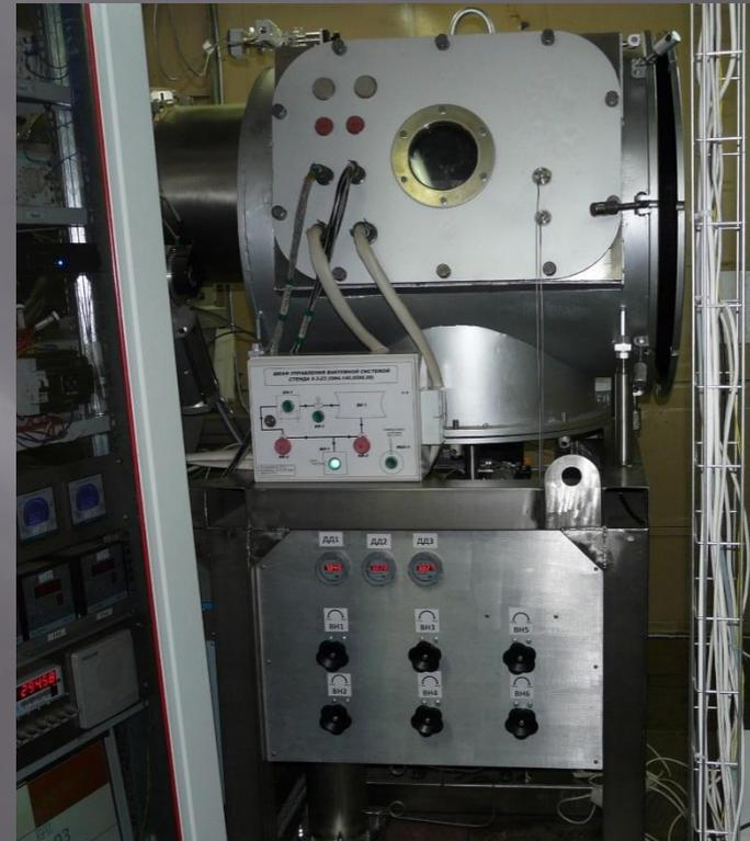
*Проведение без расходных циклических испытаний катодов.
