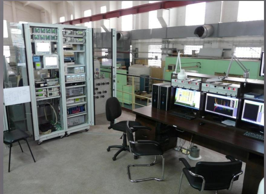
*Проведение автономных испытаний катодов, а также тепловакуумных и параметрических испытаний изделий (без измерения тяги) с расходом рабочего тела до 10 мг/с. Основные испытываемые изделия: Блок К, СПД-100, СПД-50 и их модификации.*
