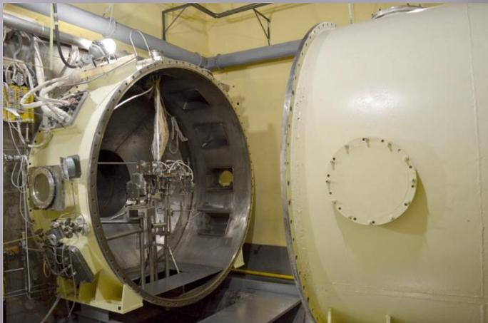
Объем вакуумной камеры  $V=16\text{м}^3$
