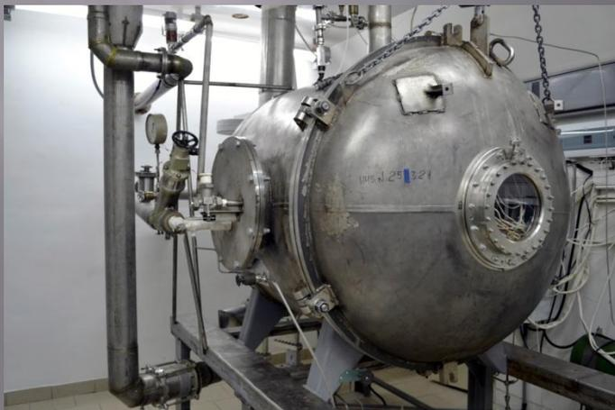
Проведение огневых и тепловакуумных испытаний действующих макетов и моделей жидкостных термokatалитических двигателей малой тяги на экологически чистом монотопливе (доводочные, предварительные, типовые)
