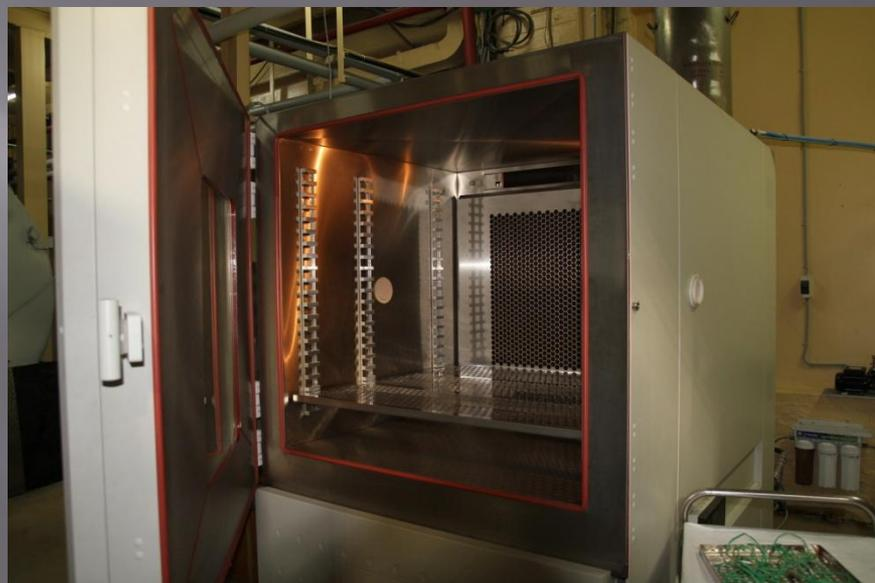
*Проведение испытаний на влажность, изменение температуры, термоциклы двигателей, двигательных установок и элементов, входящих в их состав с массой до 30 кг и габаритными размерами не более (1000 x 1000 x 1000) мм.*
