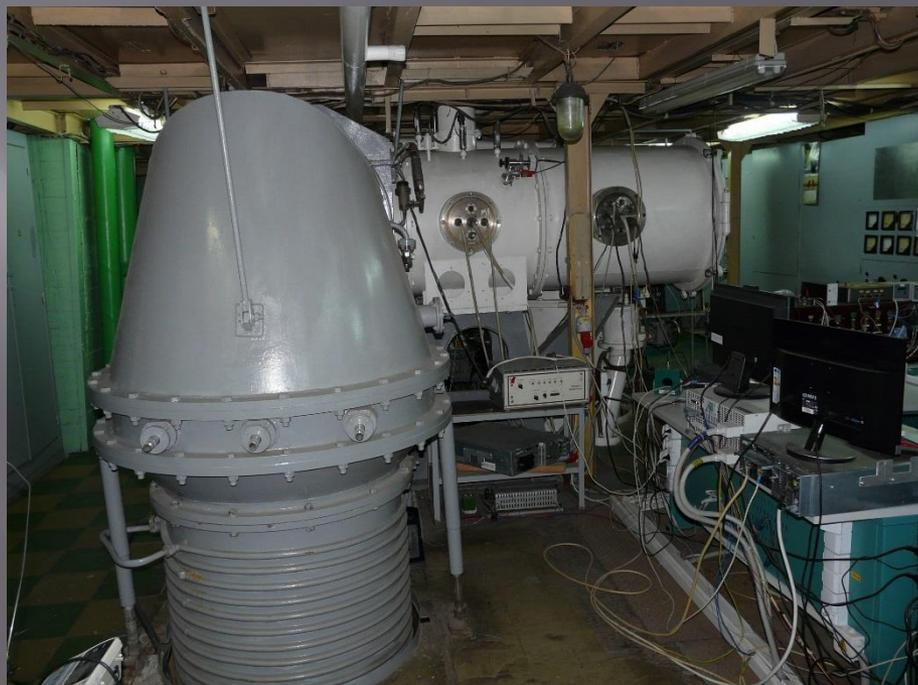
*Проведение автономных испытаний катодов, определение неравномерности распределения расхода в аноде и научно-исследовательские работы с изделиями с расходом рабочего тела до 6 мг/с.*
