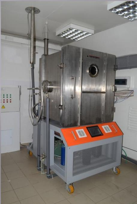
Рабочий объем вакуумной камеры  $V=1,0\text{м}^3$
