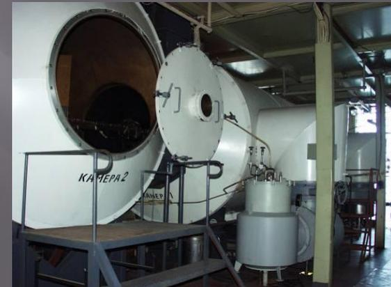
Проведение параметрических, тепловакуумных, ресурсных испытаний изделий с расходом рабочего тела до 20 мг/с.
