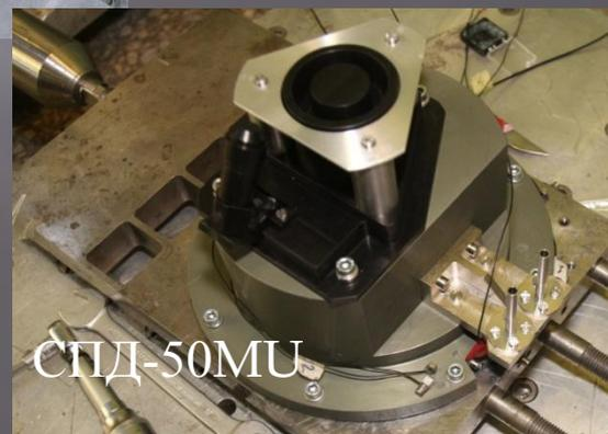
Проведение испытаний на высокоинтенсивные ударные нагрузки, двигателей и элементов двигательных установок, с массой до 10 кг и габаритными размерами не более (300 x 300 x 300) мм со значением спектра отклика удара до 7000 г.
