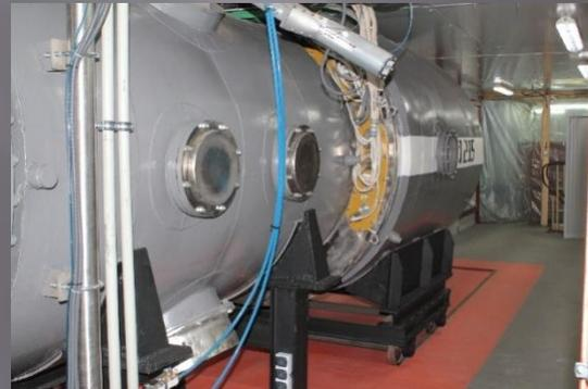
*Проведение параметрических испытаний без измерения тяги изделия с расходом рабочего тела до 10 мг/с.
