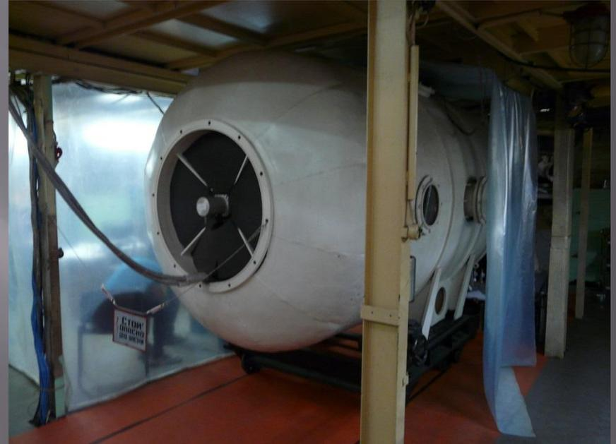
Проведение испытаний по измерению отклонения вектора тяги изделий с расходом рабочего тела до 10 мг/с. Основные испытываемые изделия: СПД-100, СПД-70, СПД-50 и их модификации.
