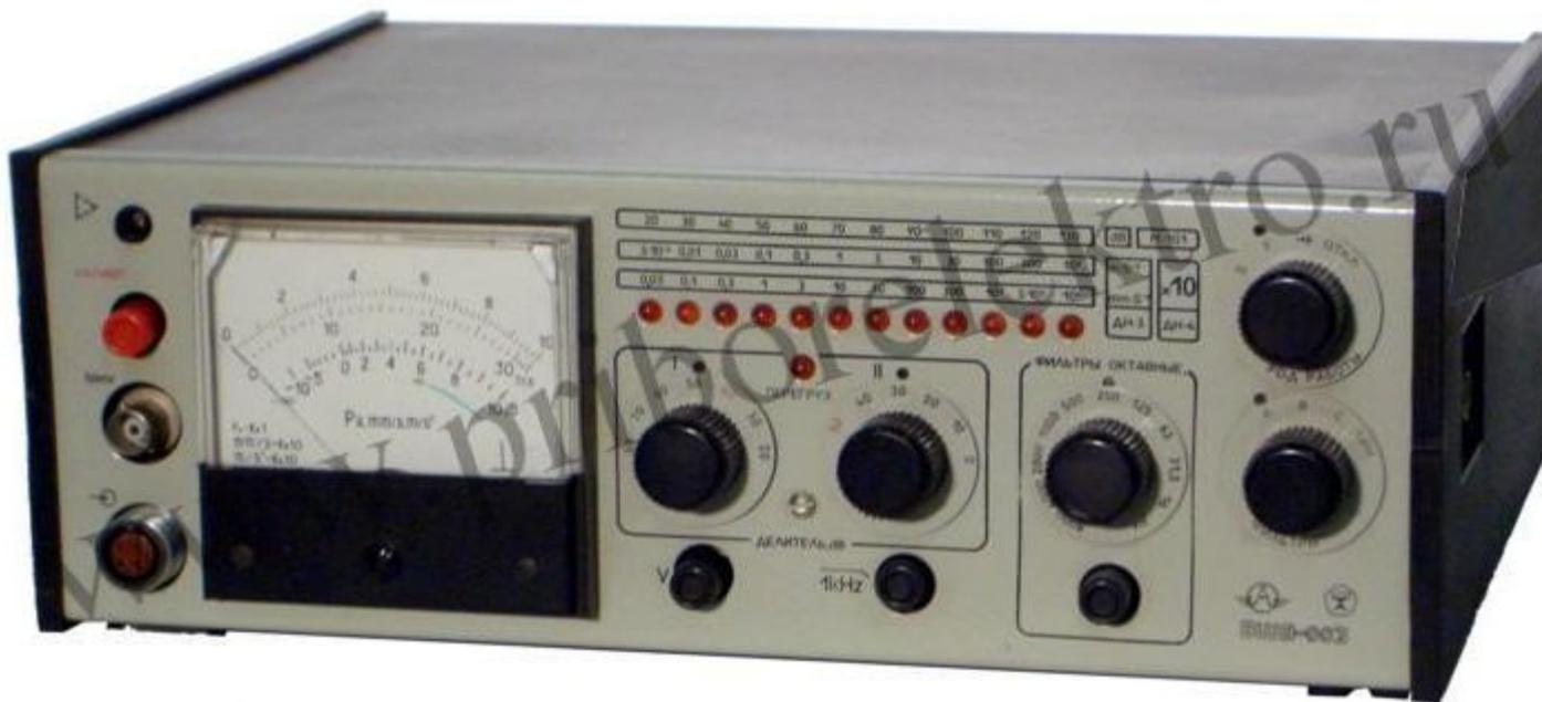
**ВШВ-003 МЗ - измеритель шума, вибрации, инфразвука и ультразвука (виброшумомер, виброметр, шумомер).**
