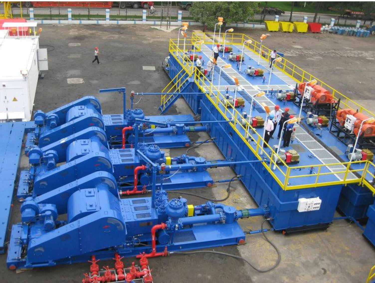
Циркуляционная система буровой установки включает в себя комплекс элементов, связанных с движением, распределением, обработкой, отводом и хранением жидкости, необходимой в процессе бурения скважин.
