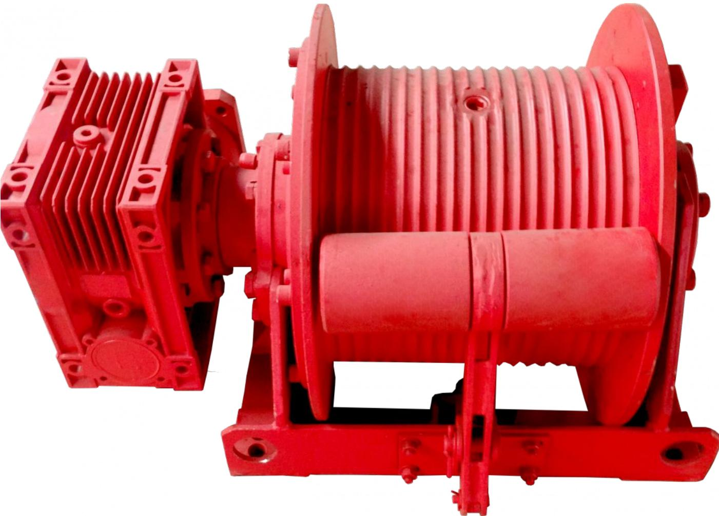
Вспомогательная лебедка служит для подъема и подтаскивания труб и другого инструмента с мостков, для установки утяжеленных труб на ручной подсвечник, а также для других вспомогательных работ по подъему, подтаскиванию грузов и по раскреплению и докреплению бурильной колонны.
