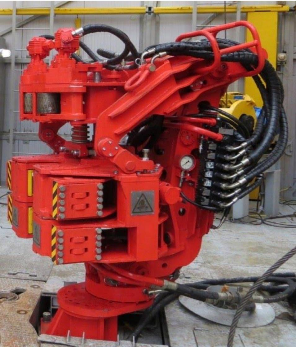
Стационарные буровые автоматические ключи - устройства, предназначенные для механизации и автоматизации сопутствующих процессов (свинчивание-развинчивание, наращивание колонны и др) в ходе спуско-подъемных операций при бурении нефтяных и газовых скважин
