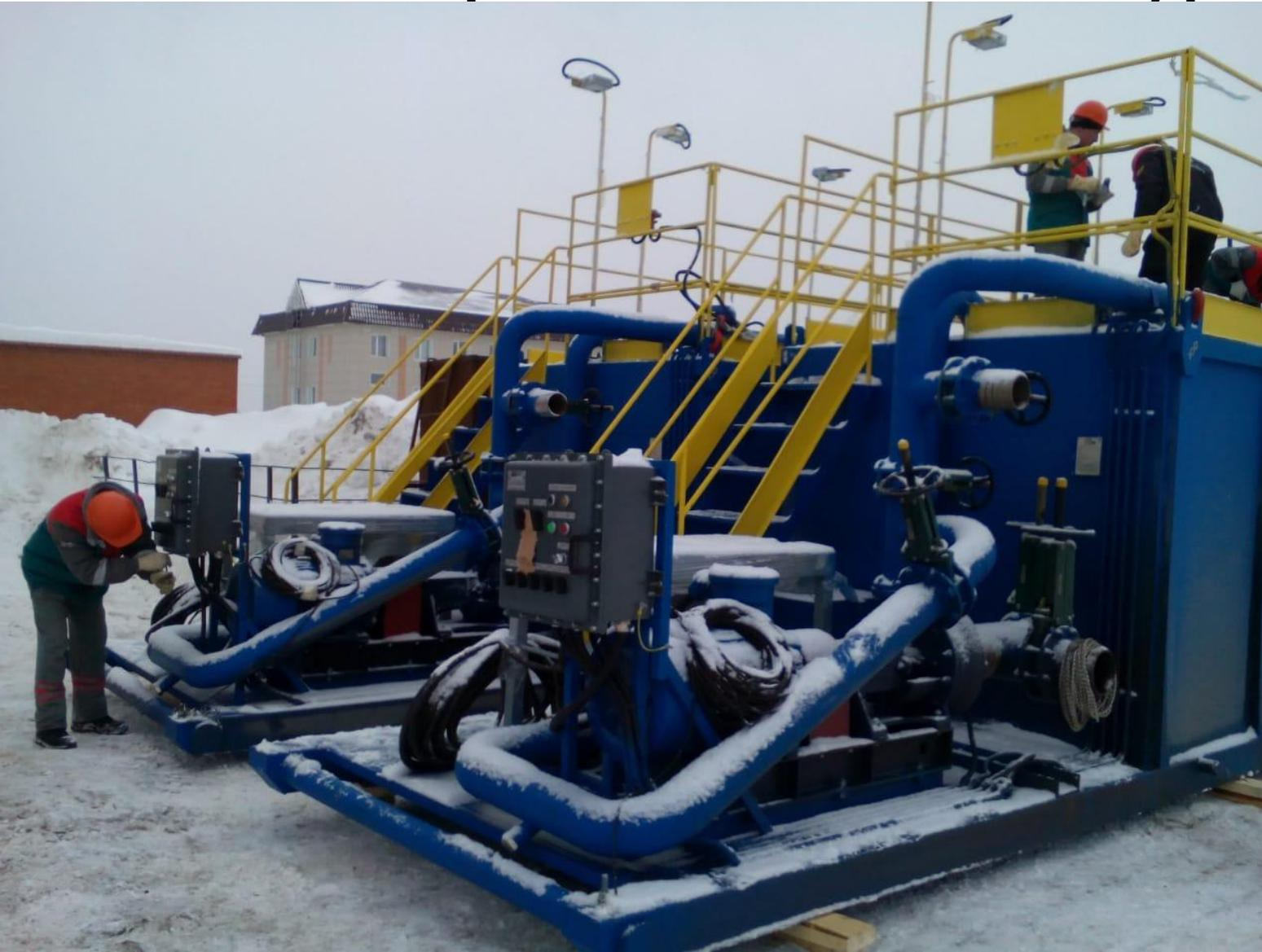
Блок приготовления бурового раствора из порошкообразных материалов состоит из двух резервуаров-силосов с фильтрами, укрепленных на основании. В нижней части силосы снабжены разгрузочным и аэрирующим устройствами. Для приготовления раствора открывается разгрузочное устройство, и порошок по шлангу поступает в гидромешалку.
