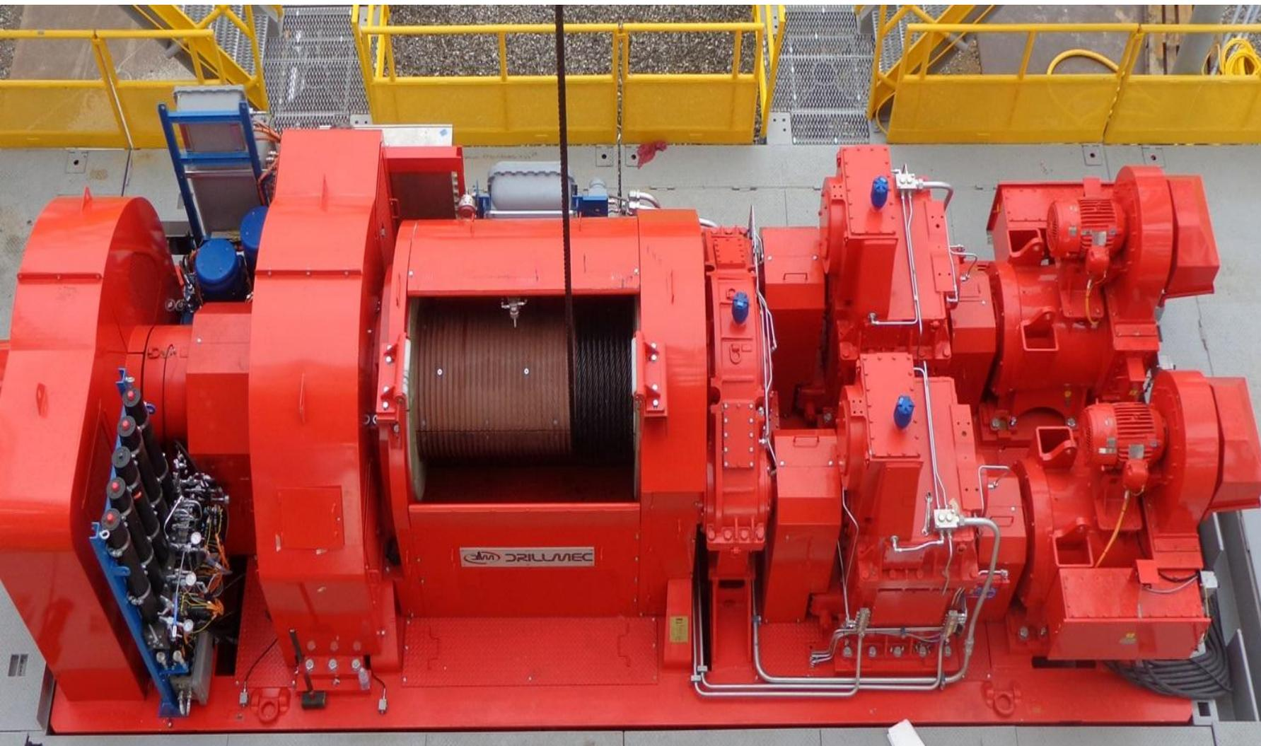
Буровые лебедки - основной исполнительный механизм для спуска и подъема бурильной колонны, медленного опускания при подаче долота на забой, спуска обсадных работ, удержания колонны на весу и др. Относится к разряду нефтегазового оборудования.
