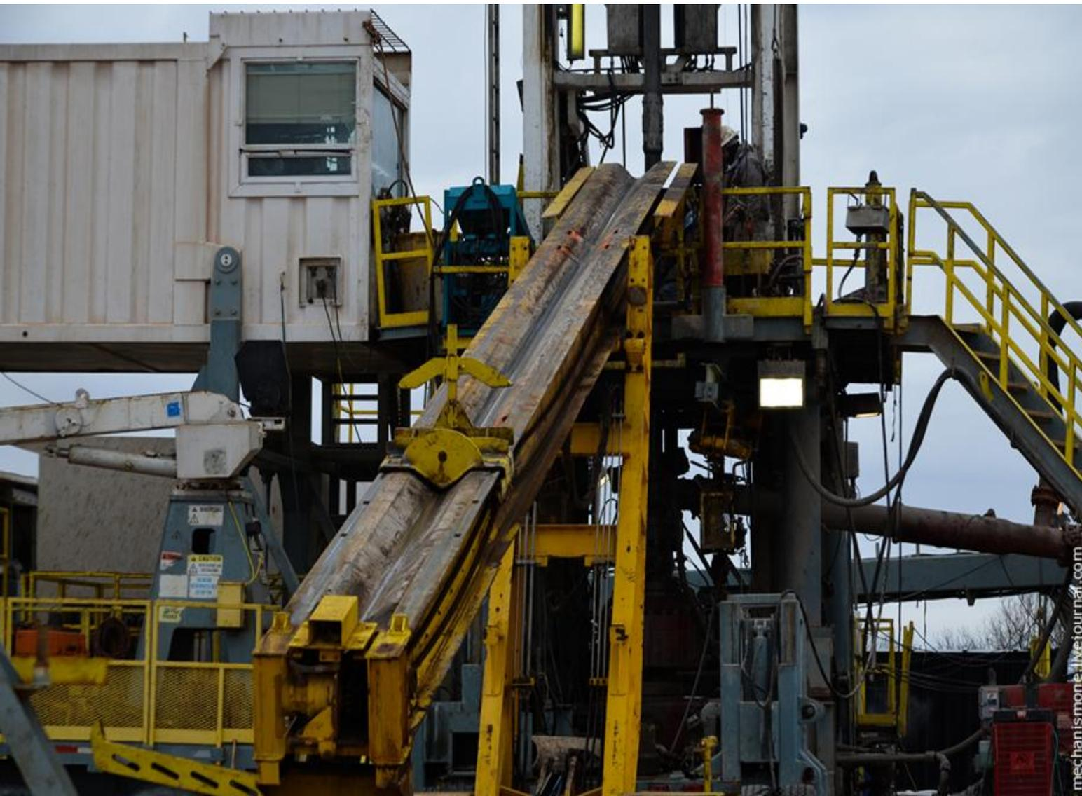
Приемный мост служит для перемещения по нему в буровую труб, оборудования и инструмента, а стеллажи — для укладки и хранения бурильных и обсадных труб.
