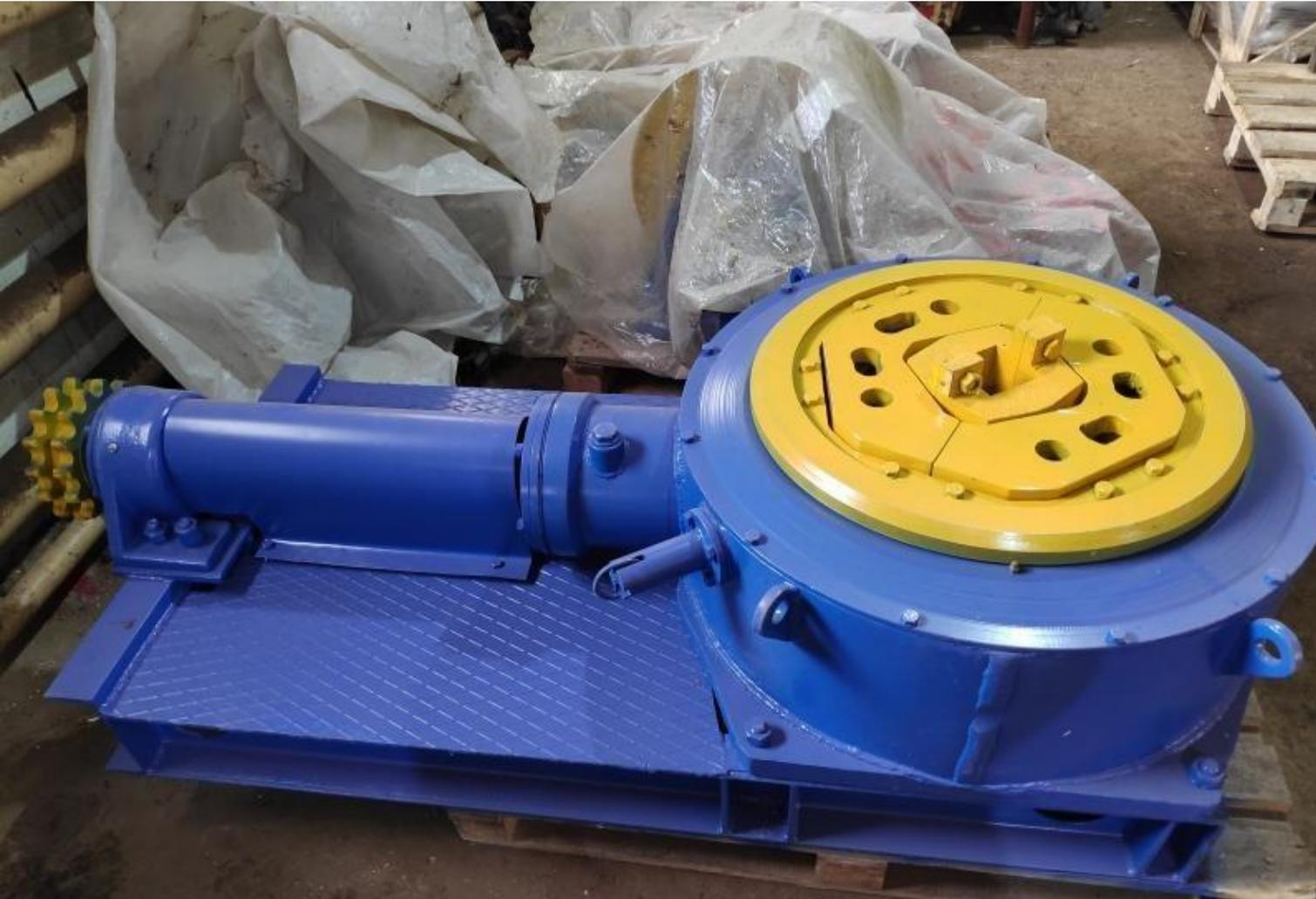
Ротор нужен для осуществления вращения бурильной колонны (подвешенной), он также необходим при бурении забойными двигателями (с его помощью осуществляется восприятие реактивного крутящего момента) и при проворачивании инструмента в ходе ловильных работ. Роторы также эффективны при поддержании обсадных труб или бурильных колонн
