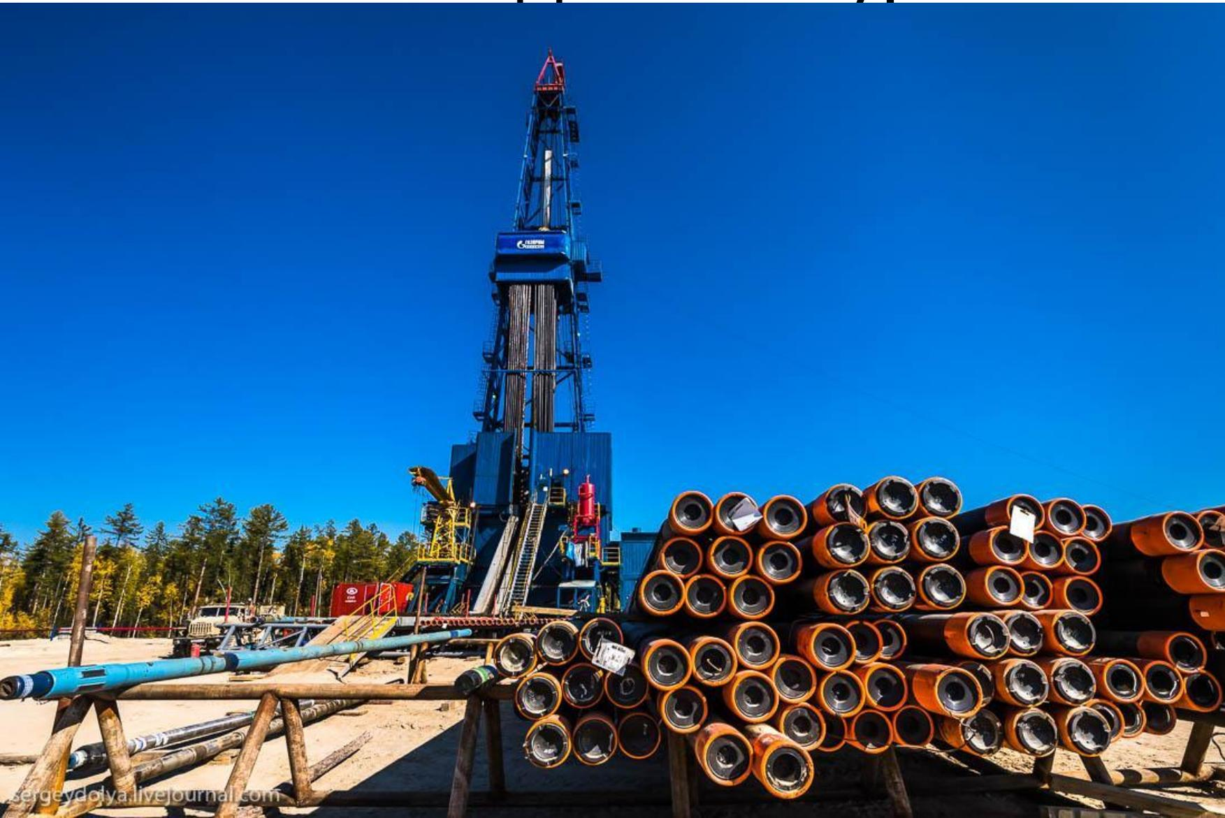
Колонна бурильных труб — связующее звено наземного оборудования с инструментом, применяемым во время ремонтно-исправительных, ловильных работ, зарезки и бурения второго-ствола и др. Она состоит из бурильных, утяжеленных бурильных труб, ведущей трубы и соединительных элементов (замков, .
