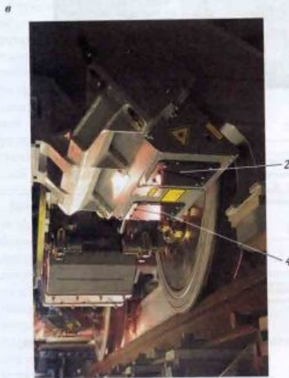
Рис. 20.4. Приборы для измерения геометрических параметров рельсов: а — схематическое размещение регистратора состояния поверхности катания головки рельса; б — регистратор боковой грани рельса; в — расположение приборов на тележке поезда: 1 — щелевая головка фоторегистратора; 2 — фоторегистратор; 3 — рама прибора; 4 — прожектор
