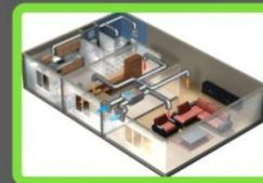
Вентиляция с рекуперацией тепла
