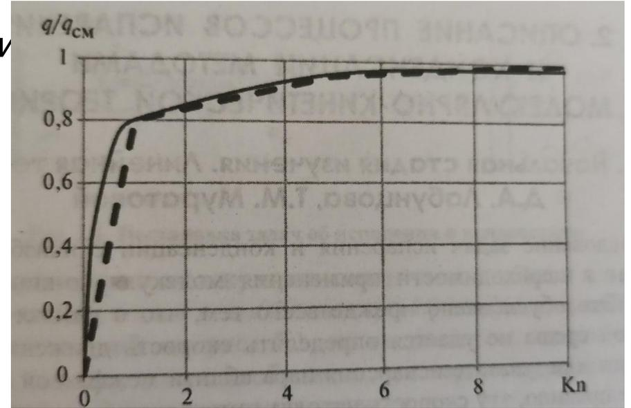
Множитель «10/8» взят из зависимости относительной плотности теплового потока от числа Кнудсена
