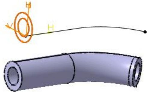
Протягивание контура по кривой
