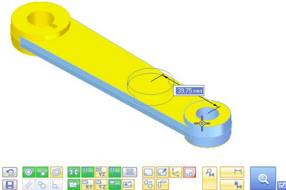
**Пример распознавания «чужой» геометрии и автоматического наложения 3D-связей**
