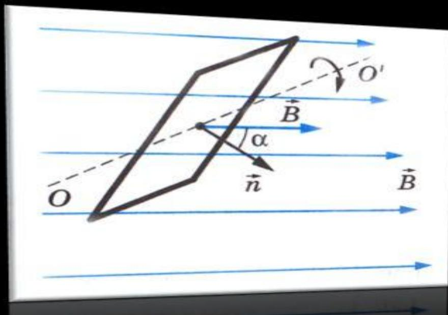
Поток магнитной индукции  $\Phi$ , пронизывающий проволочную рамку площадью  $S$ , пропорционален косинусу угла  $\alpha$  между нормалью к рамке и вектором магнитной индукции
