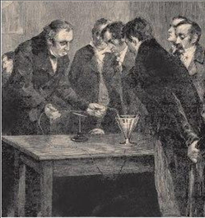
Ерстед демонструє відхилення магнітної стрілки під дією електричного струму (за рисунком Р. Шторха)
