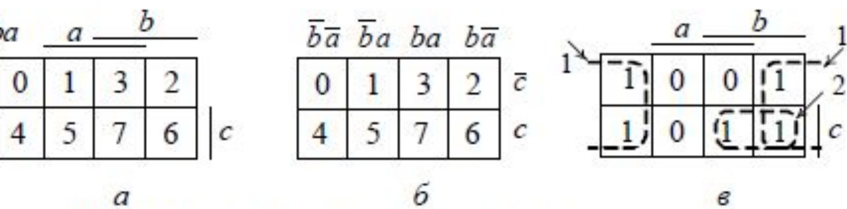
Рис. 1.11. Таблицы Карно для трех переменных: разметочные – a и – b ; рабочая карта – v
