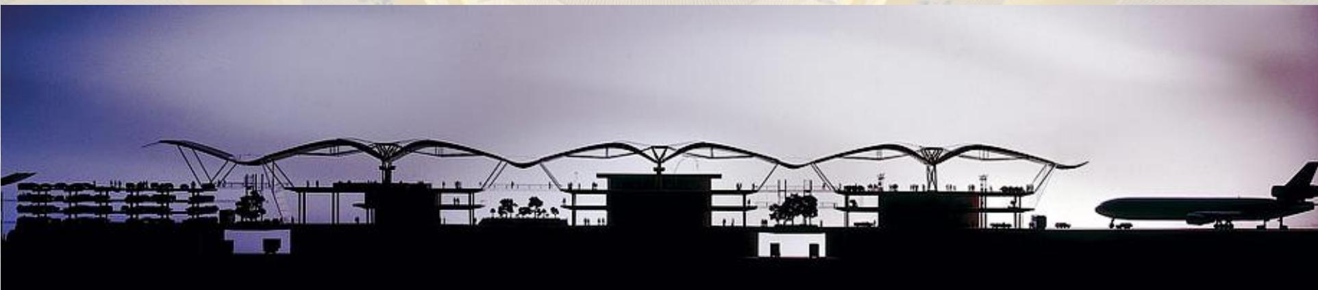
Конструкция фасада выполнена в виде кабельных ферм типа "Киппер" с центром в 9 метров (30 футов).
