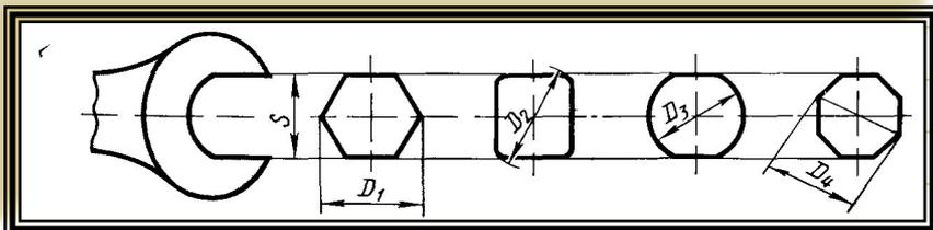
Зависимость диаметра заготовки от номинального размера S (под ключ):
