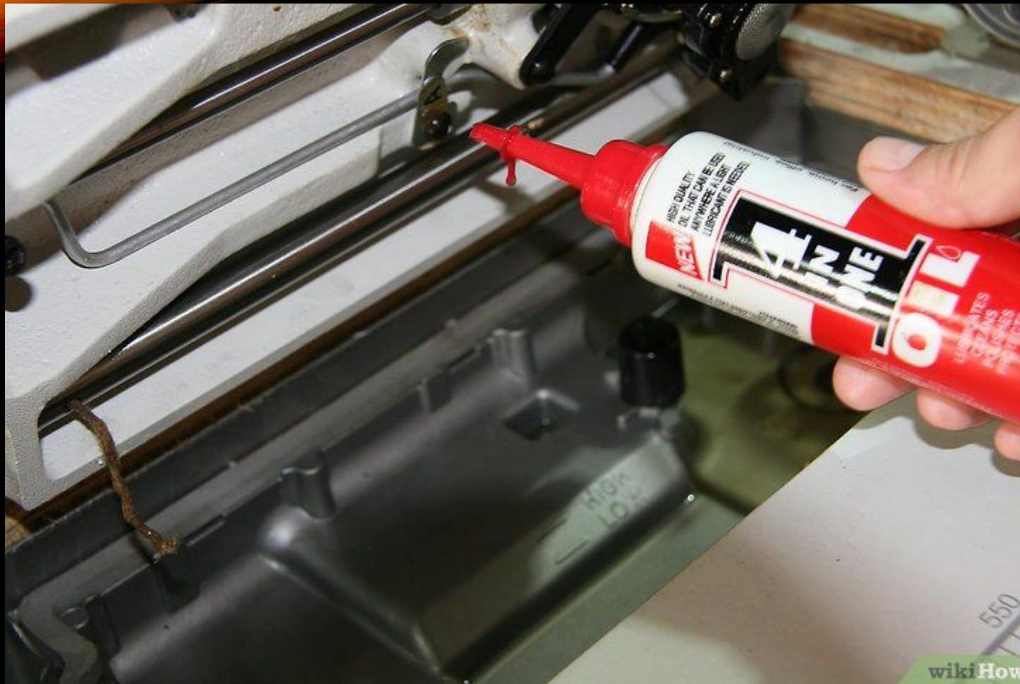
ЧИСТКА И СМАЗЫВАНИЕ ПРЕДОХРАНЯЮТ ДЕТАЛИ ОТ ПРЕЖДЕВРЕМЕННОГО ИЗНАШИВАНИЯ И ПРЕДУПРЕЖДАЮТ РЯД НЕПОЛАДОК.
