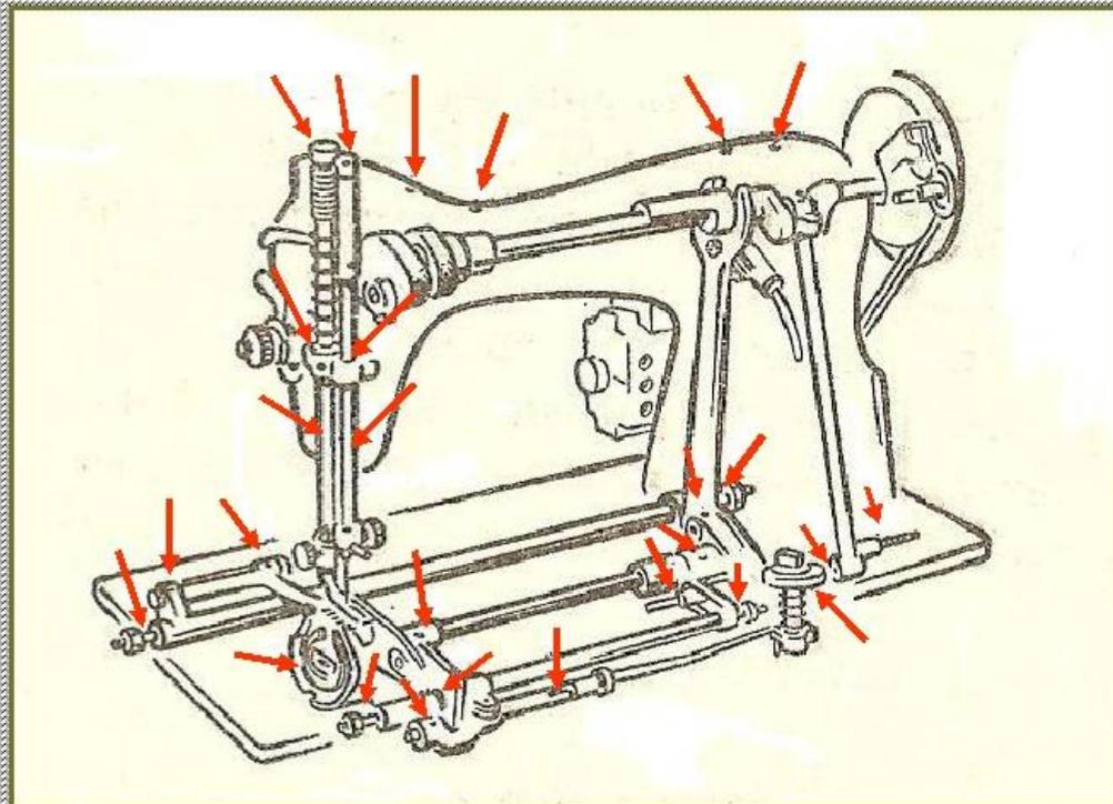
В ИНСТРУКЦИИ К МАШИНЕ ИМЕЕТСЯ РИСУНОК, НА КОТОРОМ СТРЕЛКАМИ УКАЗАНЫ МЕСТА СМАЗКИ.
