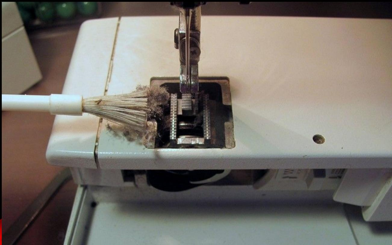
В процессе шитья в машине скапливаются пыль, очёсы от обрабатываемой ткани, концы оборванных ниток. Особенно быстро загрязняются механизм перемещения ткани, челночное устройство, шпульный колпачок.
