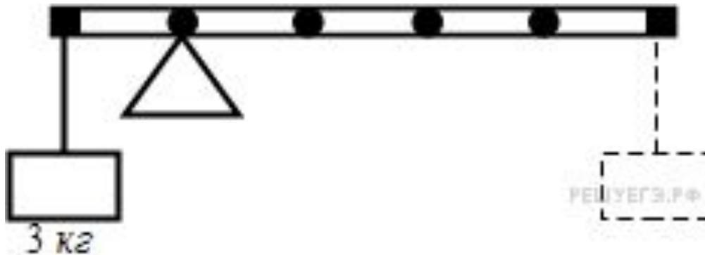
Стержень расположили на опоре, отстоящей от его левого конца на 0,2 длины стержня. Чему равна масса груза, который надо подвесить к правому концу стержня, чтобы он находился в равновесии? \_\_\_ кг
