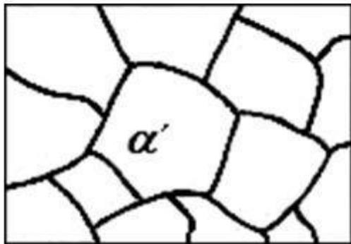
При нагреве в печи частицы  $\text{CuAl}_2$  растворяются в твердом растворе  $\alpha$  - структура станет однофазной. Затем при быстром охлаждении в воду – медь не успевает выделиться из твердого раствора и сохранится в нем после охлаждения. В результате сформируется пересыщенный твердый раствор замещения меди в алюминии –  $\alpha'$ .
