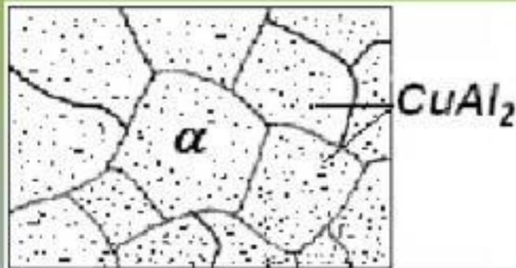
При выдержке закаленного сплава, в пересыщенном  $\alpha'$  - твердом растворе происходит диффузионное перераспределение атомов меди с формированием мелкодисперсных (30 нм) частиц  $CuAl_2$ .
