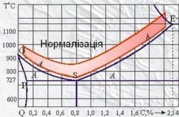
**Нормализация** от отжига отличается тем, что охлаждение стальных изделий после выдержки в печи осуществляют ускоренно - в спокойном воздухе или в его струе (от вентилятора). Для нормализации сталь нагревают до полной перекристаллизации, т.е. на 30 ... 50 °С выше критической точки
