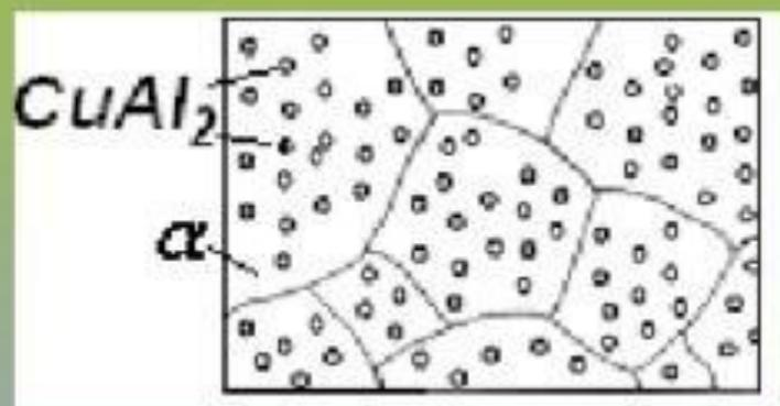
В отожженном – равновесном состоянии структура дуралюмина состоит из зерен твердого раствора меди в алюминии и частиц соединения  $\text{CuAl}_2$ . При этом частицы  $\text{CuAl}_2$  крупные.
