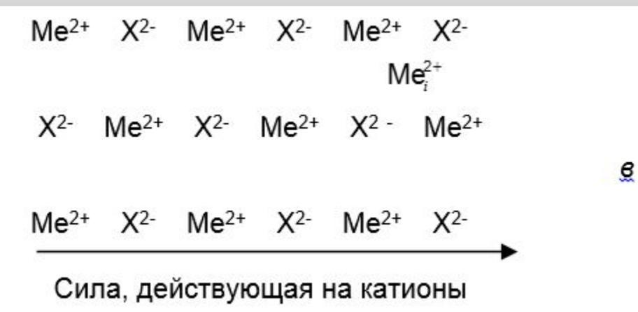
**Чем больше точечных структурных дефектов** присутствует в данном объеме КР, тем **большее число ионов** может перемещаться в этом объеме одновременно, и тем **быстрее** будут **возникать новые плоскости КР** продукта, т.е. скорость процесса непосредственно связана с концентрацией точечных структурных дефектов.
