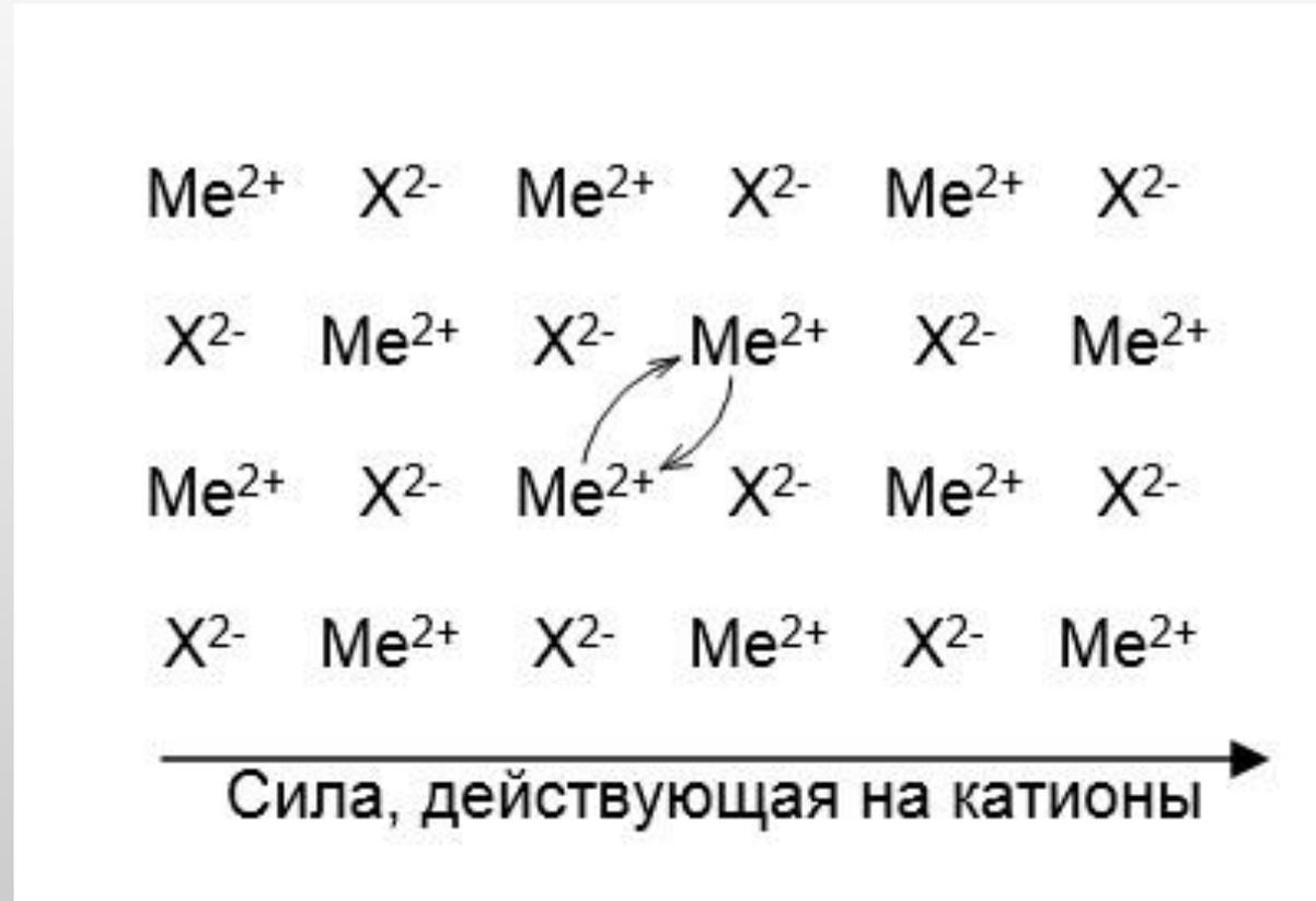
*перемещение  $Me^{2+}$  из занимаемого им узла в соседний возможно только путем обмена местами с соседним катионом*
