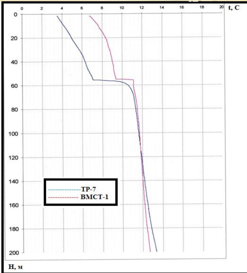
Реакция термометров ТР7-341 (синяя кривая) и ВМСТ-1 (красная кривая) на скачок температуры.
