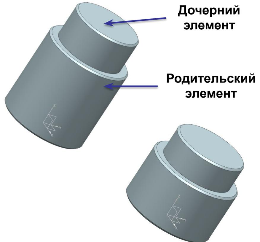
**Параметризация** – это моделирование с использованием параметров элементов модели и соотношений между этими параметрами.
