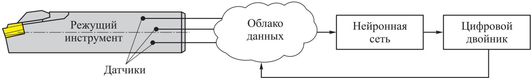
Замена сложной многомерной функциональной зависимости износостойкости  $J$  режущей части инструмента нейросетевой структурой:
