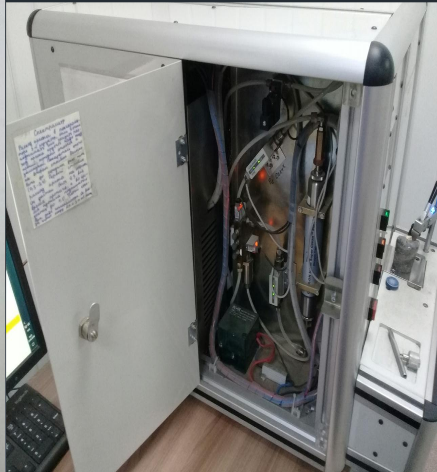
Рисунок 5а. Аргоновый блок спектрометра МСА II-V5.
