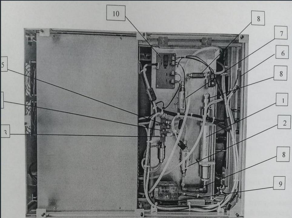
Рисунок 5а. Аргоновый блок спектрометра МСА II-V5.
