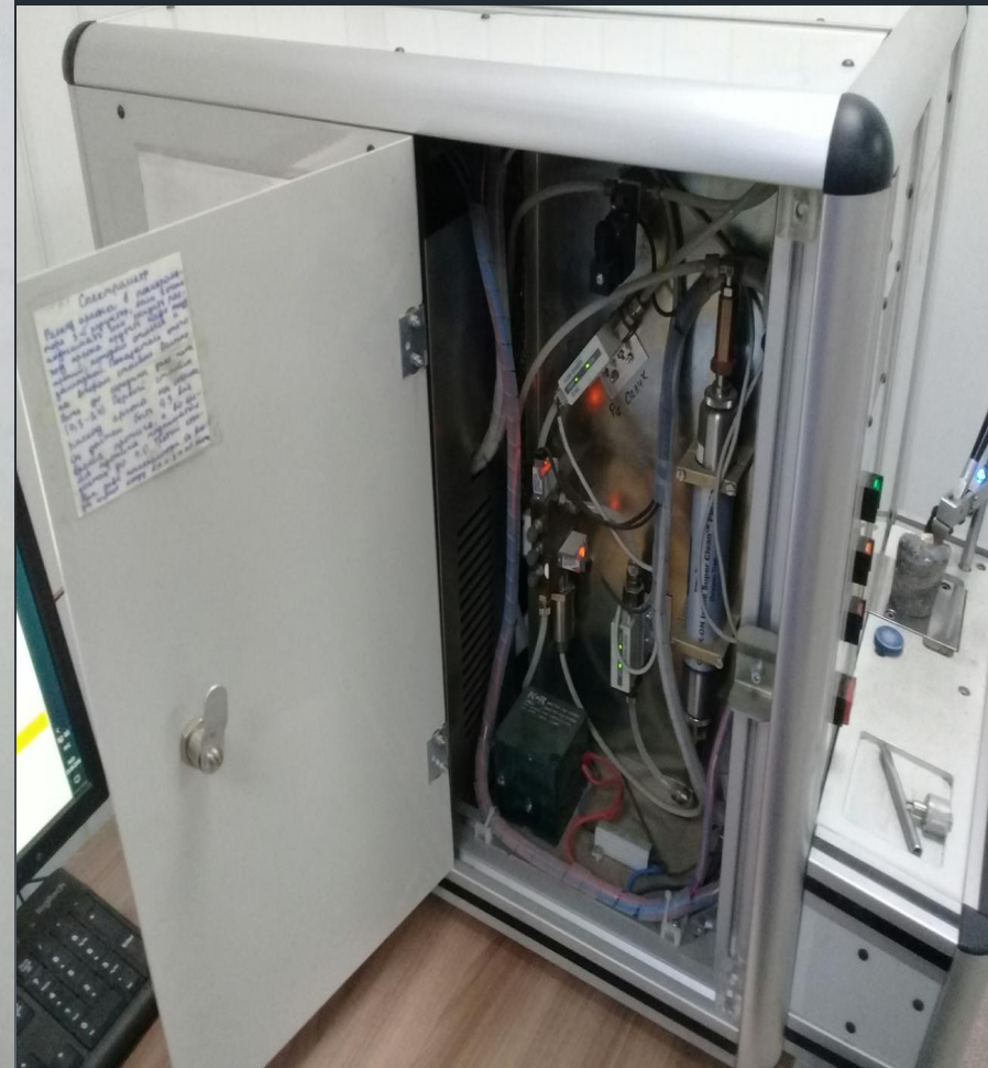
Рисунок 5а. Аргоновый блок спектрометра МСА II-V5.
