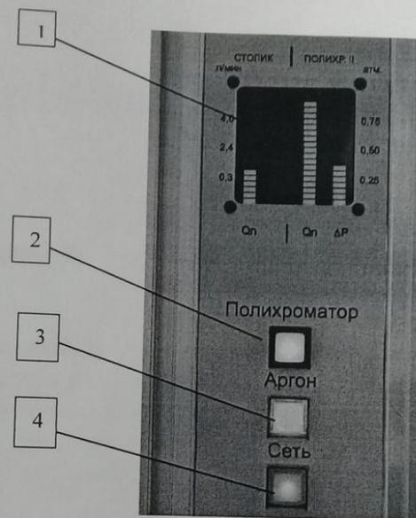
Рис.5 Панель аргонового блока.
