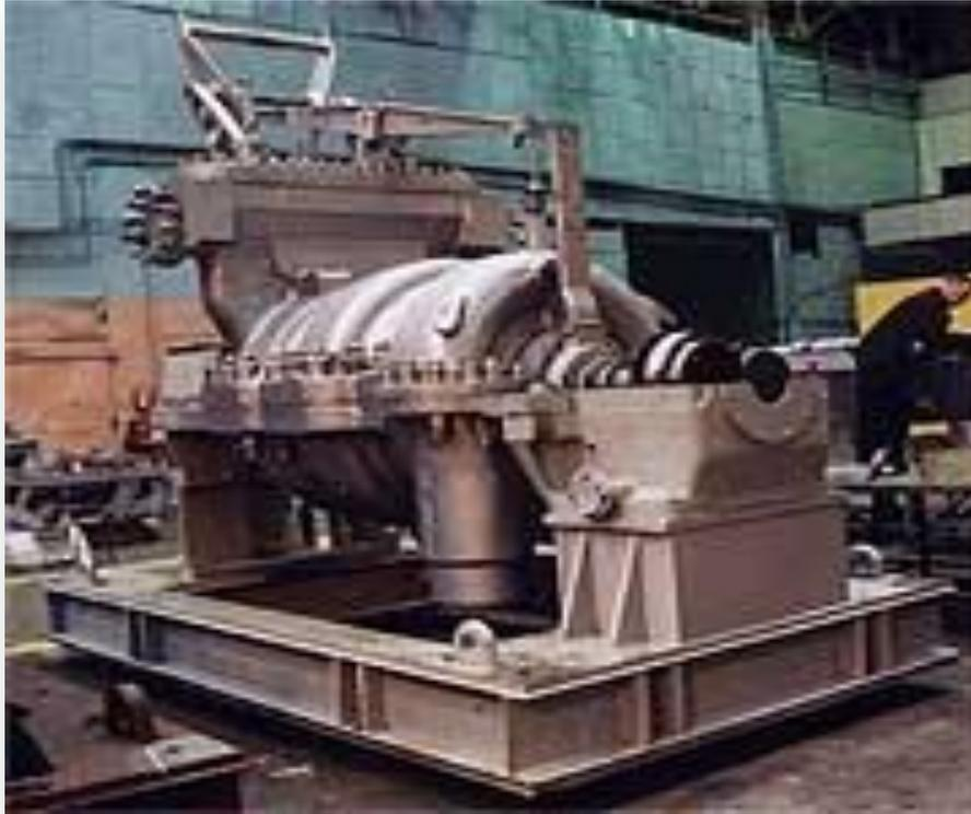
это тепловой двигатель непрерывного действия, в котором **потенциальная** энергия сжатого и нагретого водяного пара преобразуется в **кинетическую**, которая в свою очередь совершает **механическую работу** на валу.
