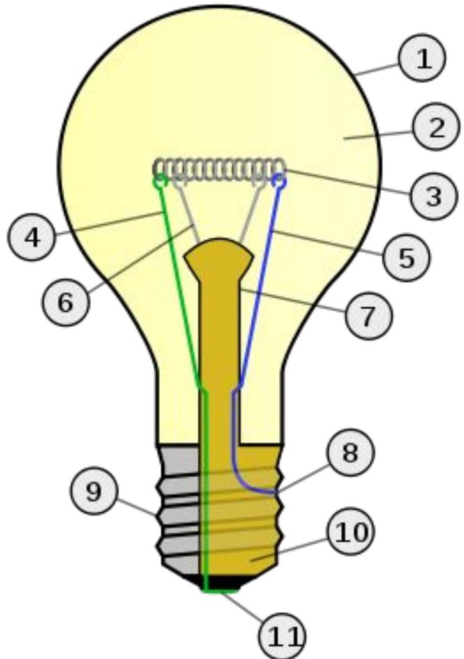
1 — колба; 2 — полость колбы (вакуумированная или наполненная газом); 3 — тело накала; 4, 5 — электроды (токовые вводы); 6 — крючки-держатели тела накала; 7 — ножка лампы; 8 — внешнее звено токоввода, предохранитель; 9 — корпус цоколя; 10 — изолятор цоколя (стекло); 11 — контакт донышка цоколя.
