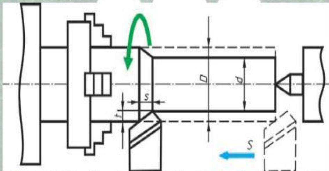
$S$  — подача,  $t$  — глубина резания,  $D$  — диаметр заготовки до точения,  $d$  — диаметр после парохода резца.
