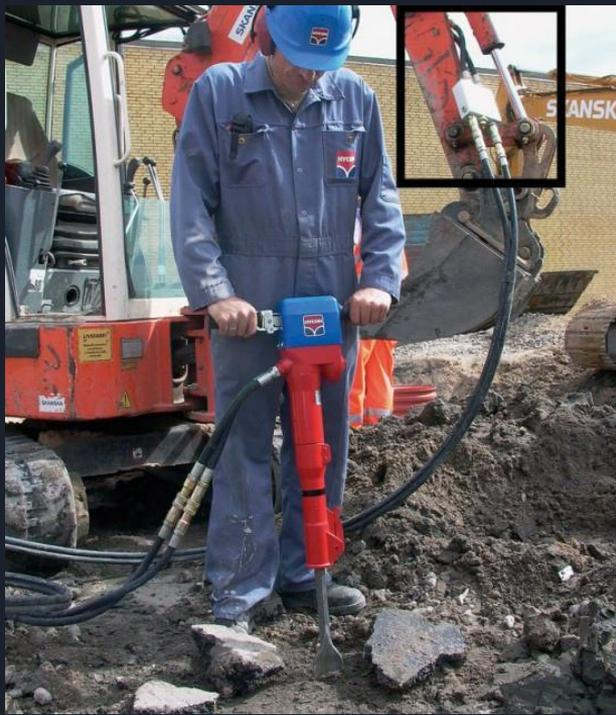
Изобретение относится к ударным устройствам, а именно к гидравлическим отбойным молоткам. Отбойный молоток содержит монолитный корпус с поршневым штоком и поршнем, подвижным ударником, рабочим инструментом и поршнем
