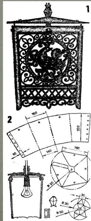
При выпиливании замкнутых контуров в металле предварительно сверлят отверстия. Для контуров сложной формы и большой протяженности используют специальный инструмент – слесарный лобзик. Слесарный лобзик представляет собой облегченный ножовку с тонкой пилкой. При выпиливании контуров в листовом металле используют **выпиловочный столик**. Начинают с внутренних элементов.
