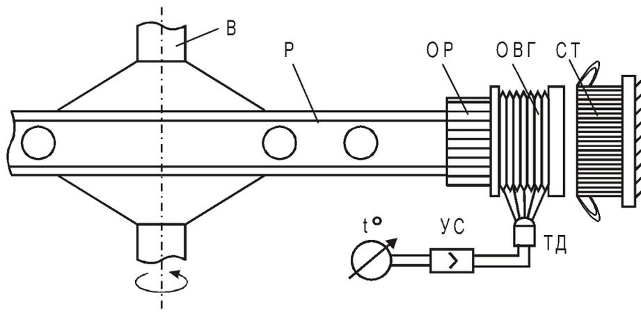
На валу В генератора вращается ротор Р с ободом ротора ОР и обмоткой возбуждения полюсов ОВГ. Под полюсами ротора неподвижно установлен термодатчик ТД, воспринимающий инфракрасное излучение нагретой ОВГ, пропорциональное температуре ОВГ. Усиленный в усилителе УС сигнал от ТД поступает на измерительный градуированный прибор. Система относительно проста и надежна.
