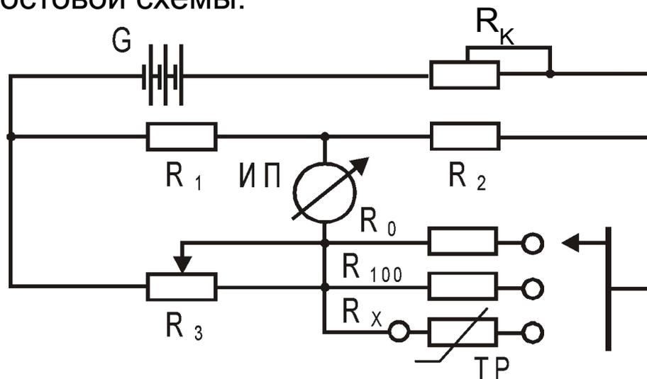
При включении  $R_0$  мост балансируется посредством  $R_3$  на «ноль», при включении  $R_{100}$  измерительный прибор ИП посредством  $R_K$  устанавливается на отметку «100 делений», соответствующую  $100^{\circ}\text{C}$ . Для измерения температуры включается  $R_X$ , представляющий собой терморезистор ТР, установленный на объекте.
