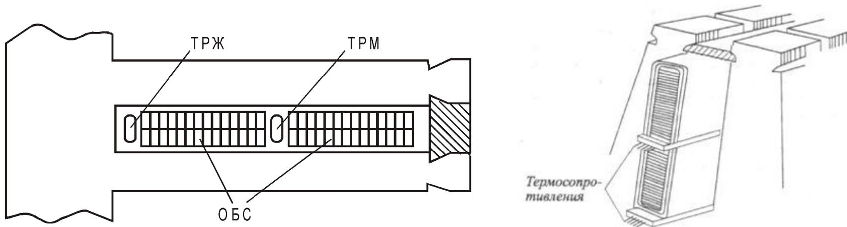
Разрез по пазу статора генератора с терморезисторами: ТРЖ измеряет температуру железа  $\vartheta_{ж}$ , ТРМ измеряет температуру меди  $\vartheta_{М}$ , ОБС - обмотка статора
