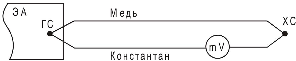
«Горячий спай» ГС находится на объекте измерения - электрическом аппарате ЭА, температура «холодного спая» ХС должна быть точно известна.
