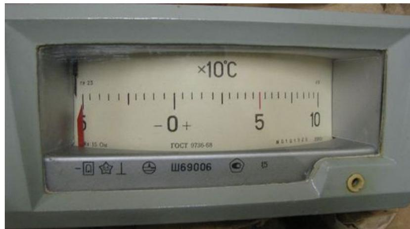
Логометр ЛОГ сравнивает два тока, протекающих по обмоткам I и II. В обмотке I протекает ток, величина которого зависит от сопротивления ТР, а следовательно, от измеряемой температуры, а ток в обмотке II регулируется потенциометром  $R_{\text{к}}$
