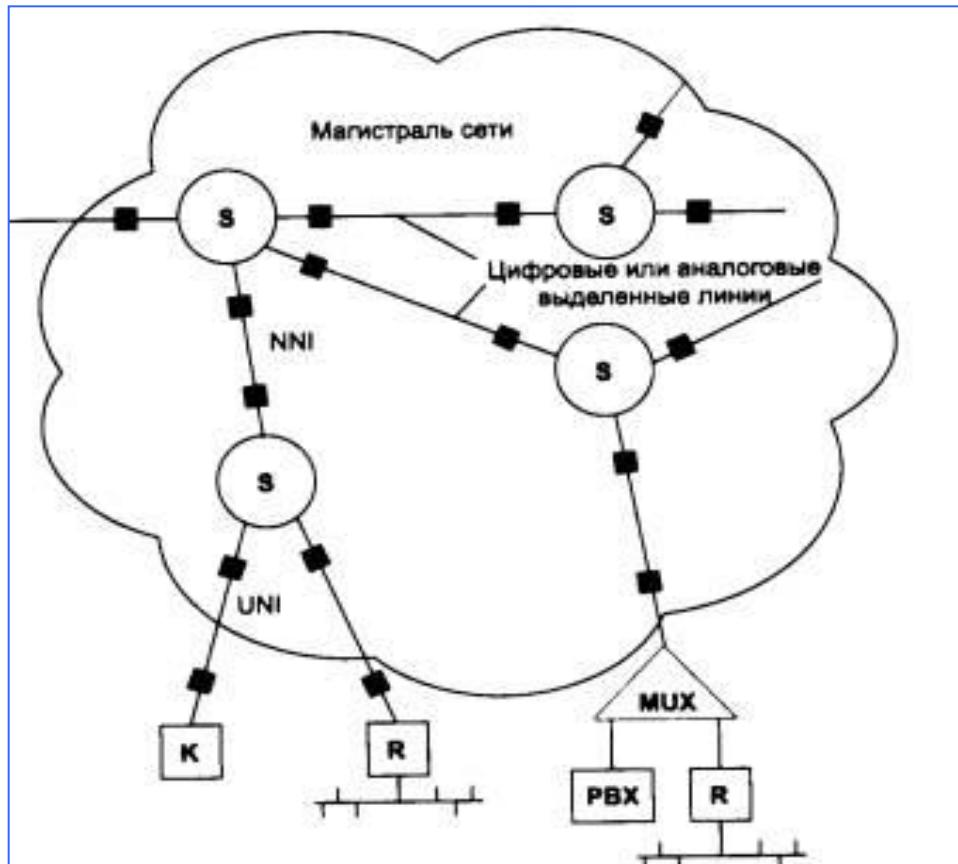
Типичный пример структуры глобальной компьютерной сети приведен на рисунке. Здесь используются следующие обозначения:
