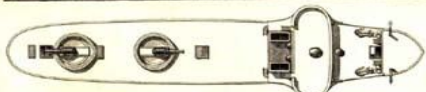
Fig. 3. Barbetteturmschiff Amiral-Duperré, Stapellauf 1870 (Frankreich).
