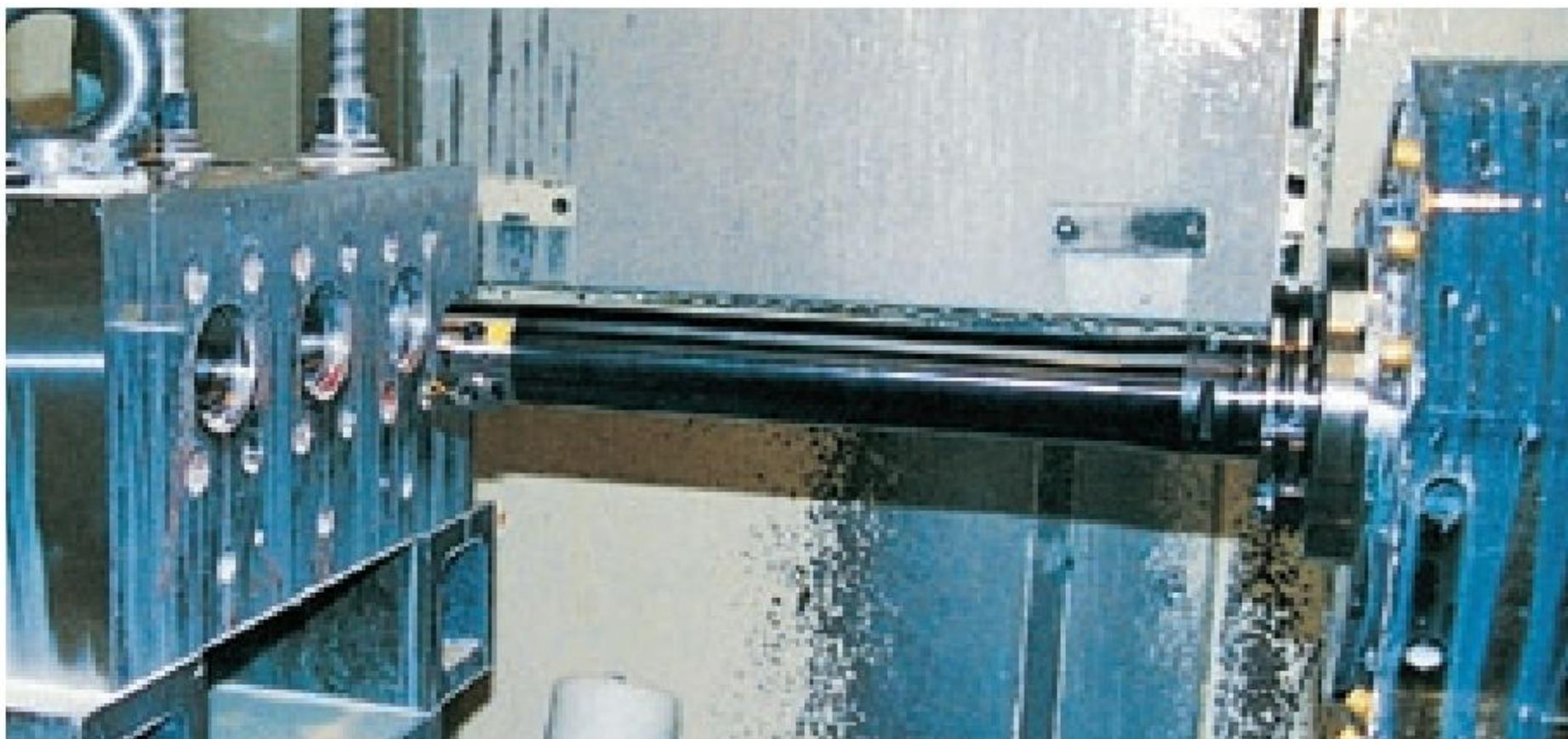
Применение antivибрационной оправки при большом вылете инструмента.
