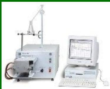
«**Фаринограф-Е**» - применяется для определения водопоглотительной способности и свойств теста из пшеничной и ржаной муки при замесе
