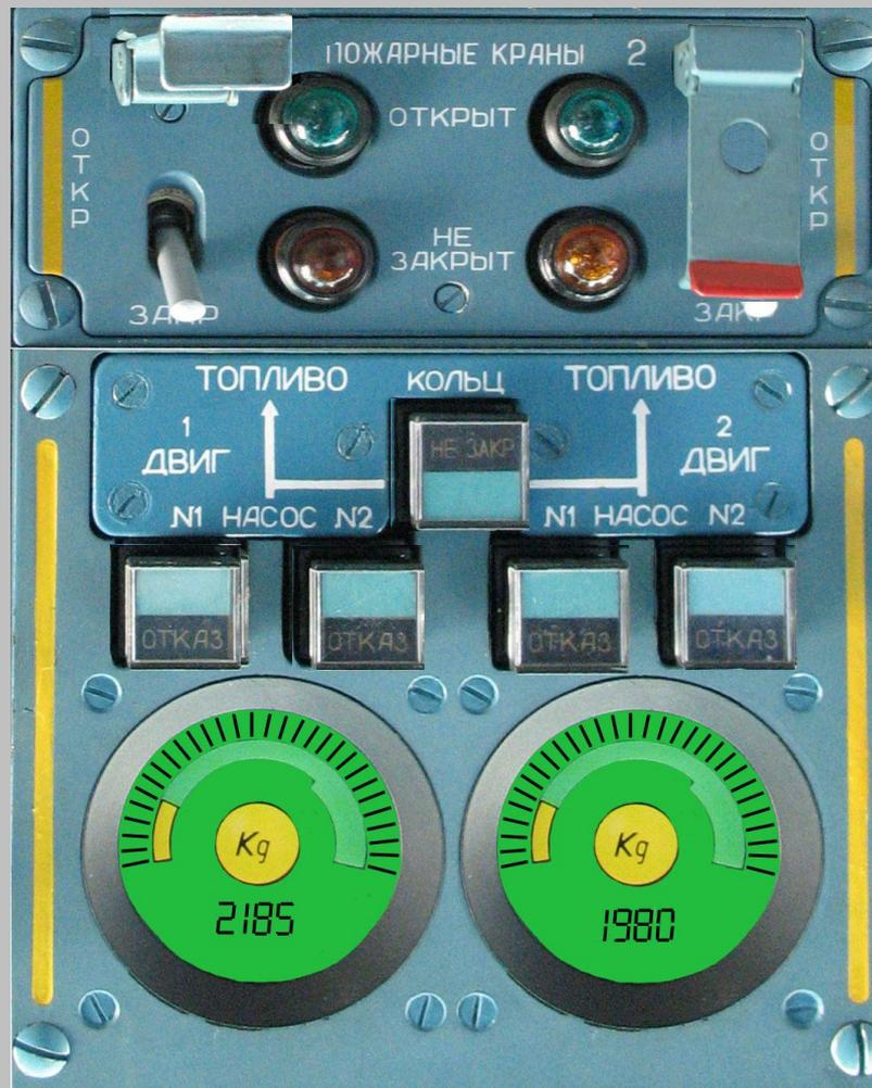
Откройте пожарные краны двигателей, установив на щитке "ПОЖАРНЫЕ КРАНЫ" два переключателя в верхнее положение. Кратковременно загорятся и погаснут светосигнализаторы "НЕ ЗАКРЫТ", загорятся светосигнализаторы "ОТКРЫТ".
