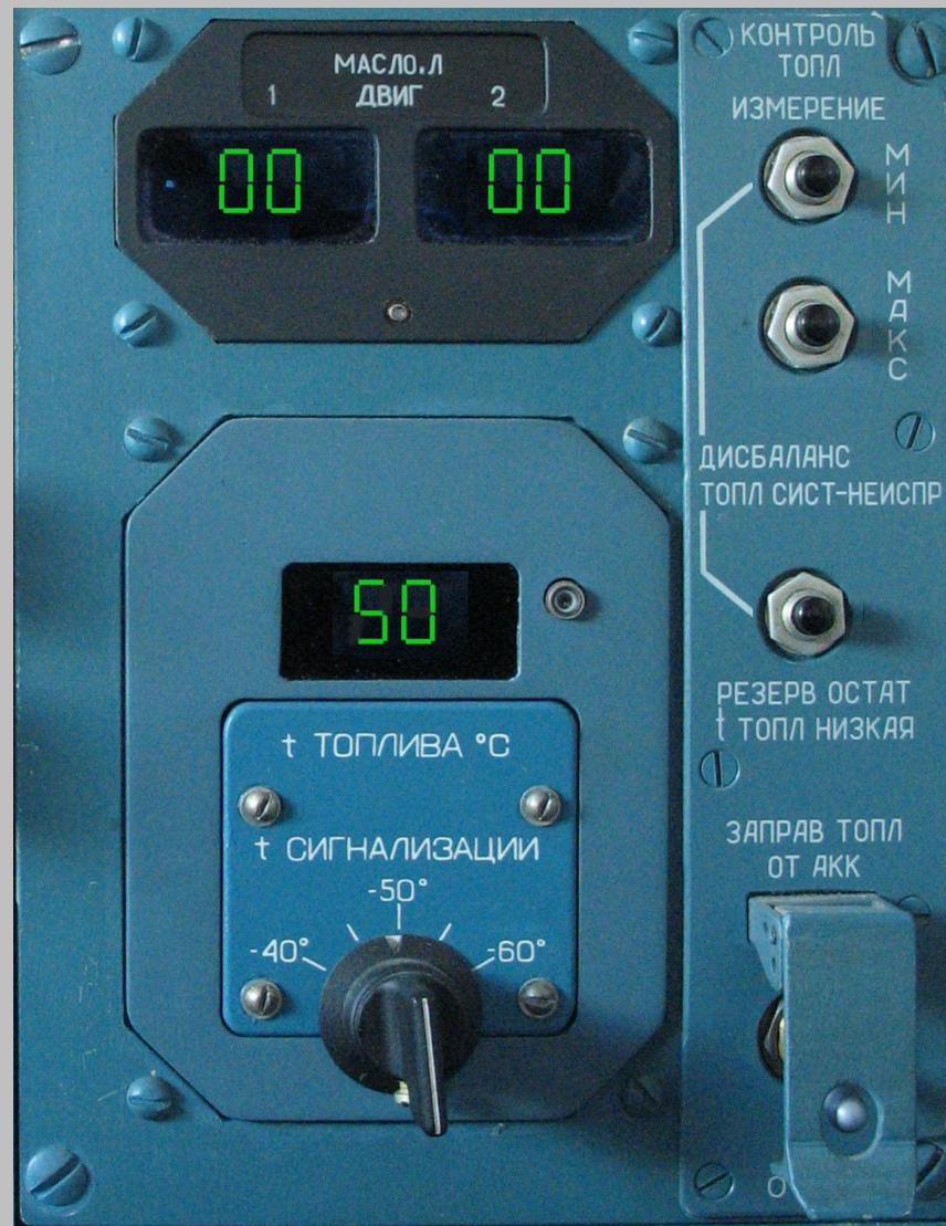
На щитке "КОНТРОЛЬ ТОПЛ" нажмите кнопку "МИН" - на цифровых индикаторах количества топлива и температуры во всех разрядах высветятся нули.
