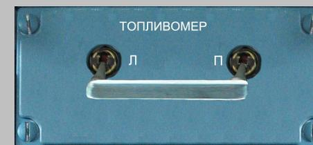
Установите переключатели "ТОПЛИВОМЕР" в верхнее положение, при этом кратковременно (1..3с) загораются табло "ТОПЛ СИСТ - НЕИСПР" и "РЕЗЕРВ ОСТАТ ТОПЛ", происходит изменение показаний топливомера, которые через короткое время (не более 60с) остановятся и покажут текущее количество топлива в баках
