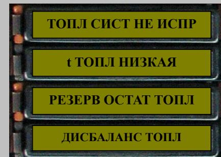
Галетным переключателем на ПКТ установите минимально допустимое значение температуры топлива, равное  $T_{HKтопл} + 5^{\circ}C$
