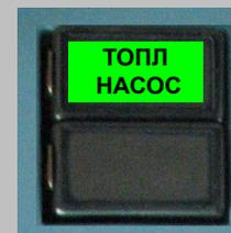
При этом на щитке "ПОЖАРНЫЙ КРАН ВСУ" кратковременно загорится и погаснет светосигнализатор "НЕ ЗАКР" и загорится "ОТКР", загорится табло "ТОПЛ НАСОС", погаснет табло "НЕТ ДАВЛ ТОПЛИВА"
