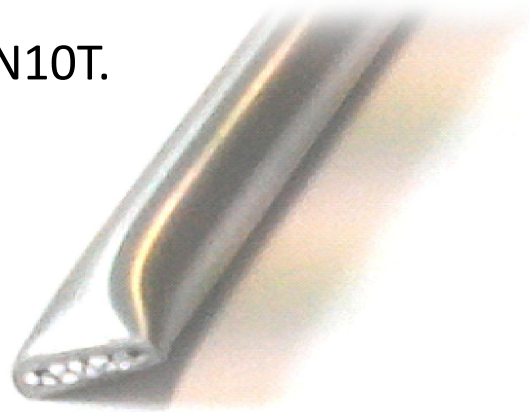
Деталь отрезанного датчика КНИ
