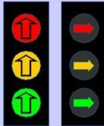
Для регулирования движения в определенных направлениях
