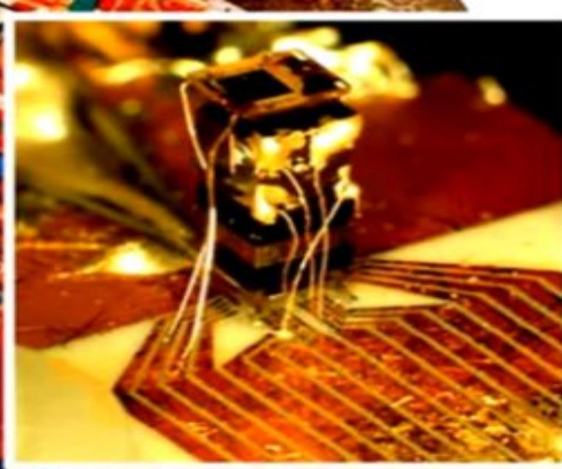
Сверхточные цезиевые часы, хранящиеся в Национальном институте стандартов и технологий США (NIST): поляризованный луч лазера проходит через ячейку с парами цезия и попадает на детектор. Период электромагнитных колебаний излучения, возникающего при переходе между двумя основными уровнями атома цезия – международный эталон времени.
