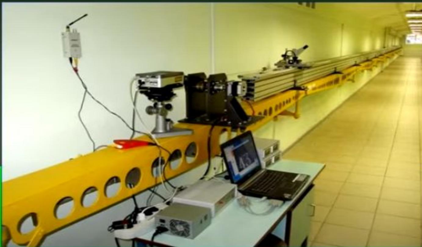
**Компаратор лазерный интерференционный тридцатиметровый**
