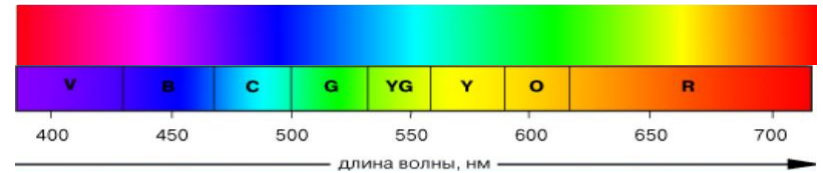
Соотношение цветового тона модели HSV (вверху) и семи цветов призматического света (внизу)
