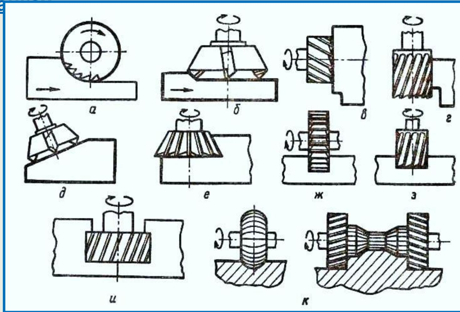
а, б – фрезерование горизонтальных поверхностей ; в, г – фрезерование вертикальных поверхностей; д, е – фрезерование наклонных поверхностей; ж, з, и – фрезерование пазов и канавок; к – фрезерование фасонных поверхностей.
