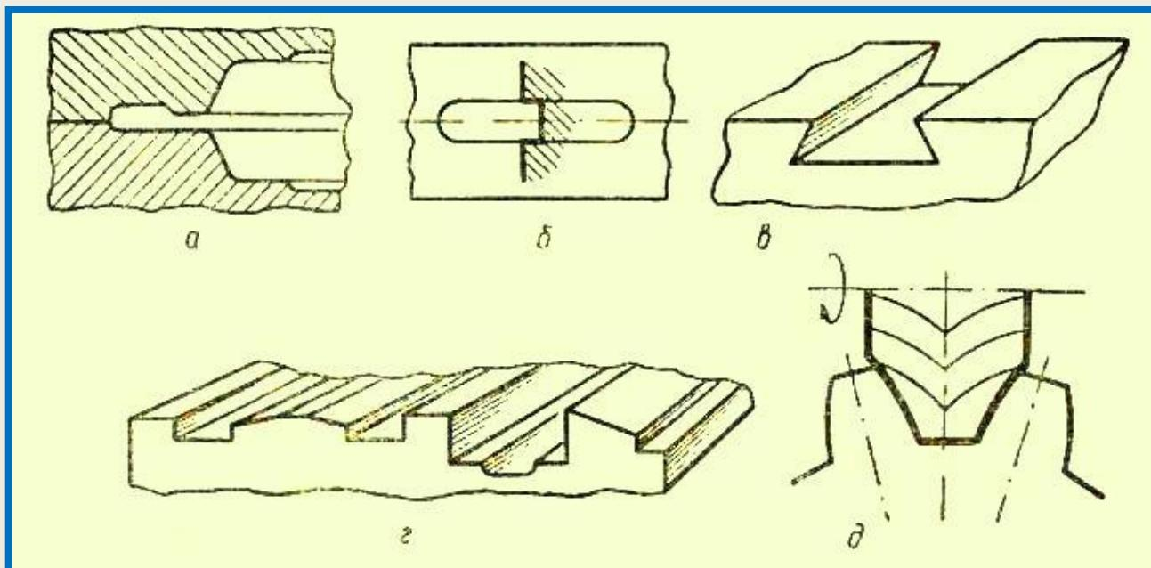
*а – гравюры штампов и пресс-форм; б – шпоночные пазы; в – направляющие типа «ласточкин хвост»; г – поверхность сложного профиля; д – поверхность зубчатых колёс, червячных передач, резьб.*
