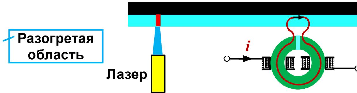
Луч лазера разогревает до точки Кюри (температуры потери ферромагнетиком магнитных свойств) микроскопическую область записывающего слоя, которая при выходе из зоны действия лазера остывает, фиксируя магнитное поле, наведённое магнитной головкой.
