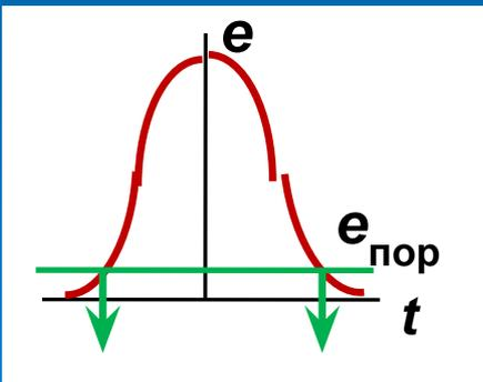
Для последующей корректной обработки электронными узлами сигналов с размытыми фронтами нужно однозначно определить моменты времени, когда электронный узел должен реагировать на входной сигнал.
