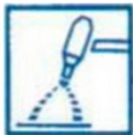
**TIG/WIG** - дуговая сварка вольфрамовым электродом (W-электродом) в среде инертного газа (способ ТИГ);
