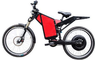
МОТОР-КОЛЕСА ДЛЯ ЭЛЕКТРОВЕЛОСИПЕДОВ МОЩНОСТЬЮ 10 КВТ И 20 КВТ
