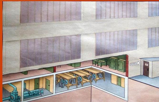
Но одной защиты ещё недостаточно. Требуется обеспечить возможность длительного пребывания людей в убежищах (до прекращения пожаров, спада уровней радиации). Для этого сооружения помимо фильтр вентиляции, снабжающей людей воздухом, пригодным для дыхания, должны иметь надежное электропитание, санитарно-технические устройства (водопровод, канализацию, отопление), а также запасы воды и продовольствия.
