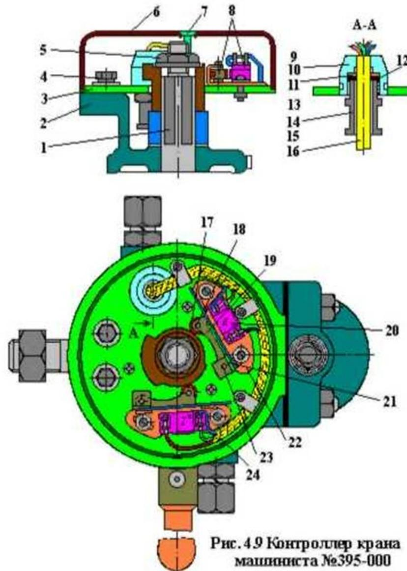
Рис. 4.9 Контроллер крана
