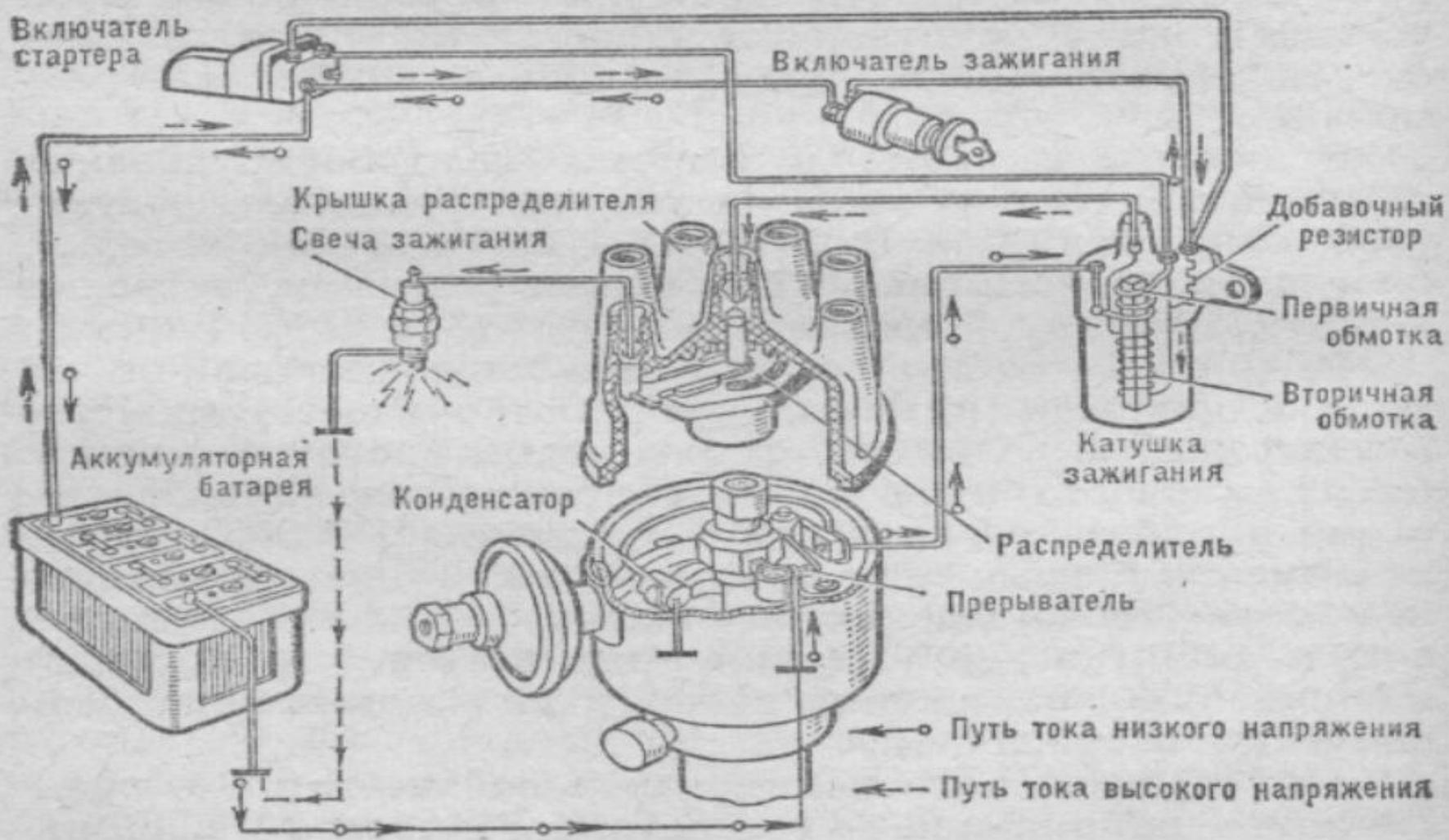
Рис. 23 Схема батарейного зажигания
