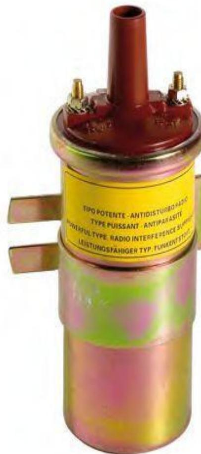
Опишите устройство и принцип работы катушки зажигания
