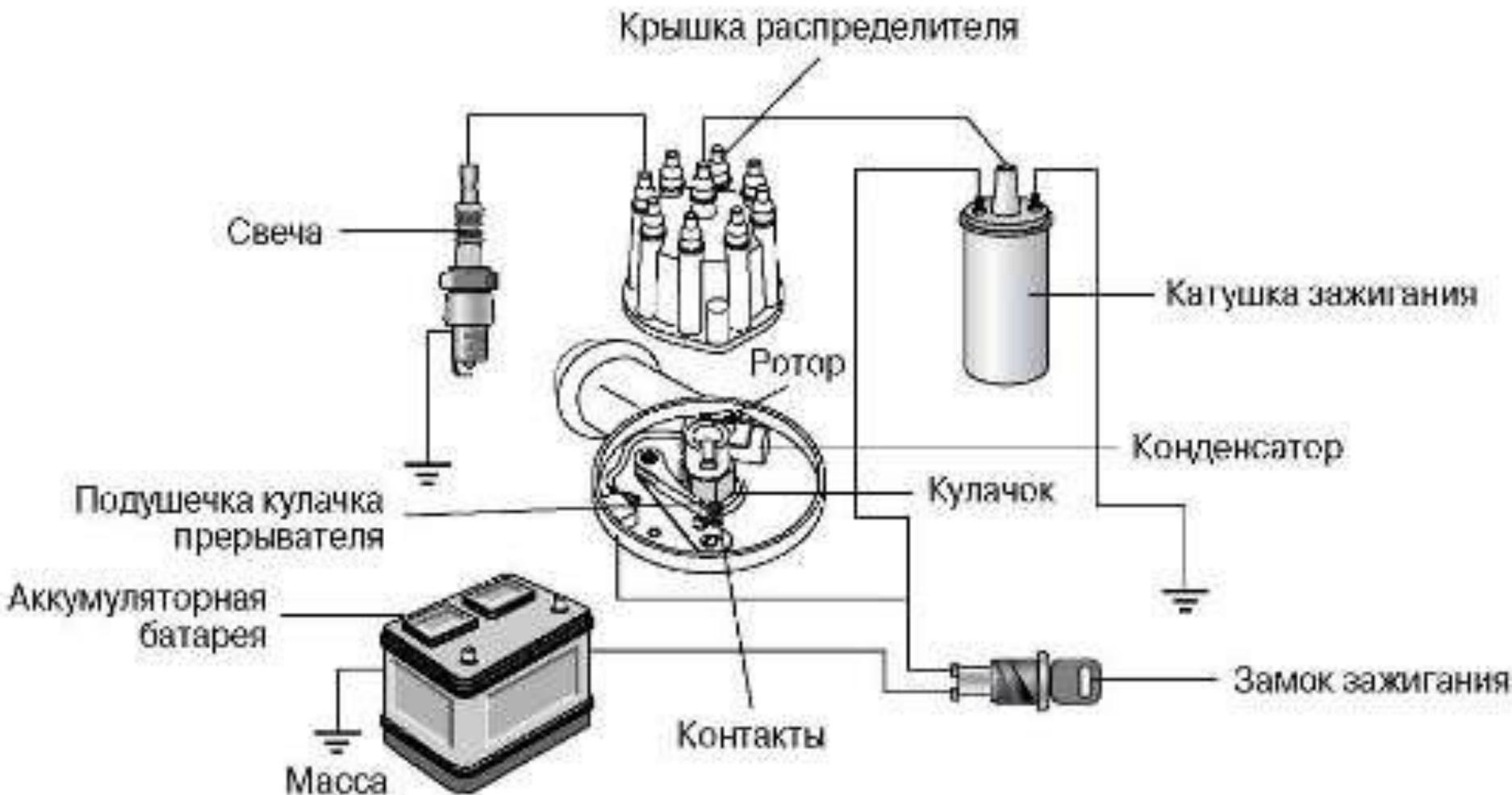
Рис. 5.8. Схема обычной незлектронной системы зажигания
