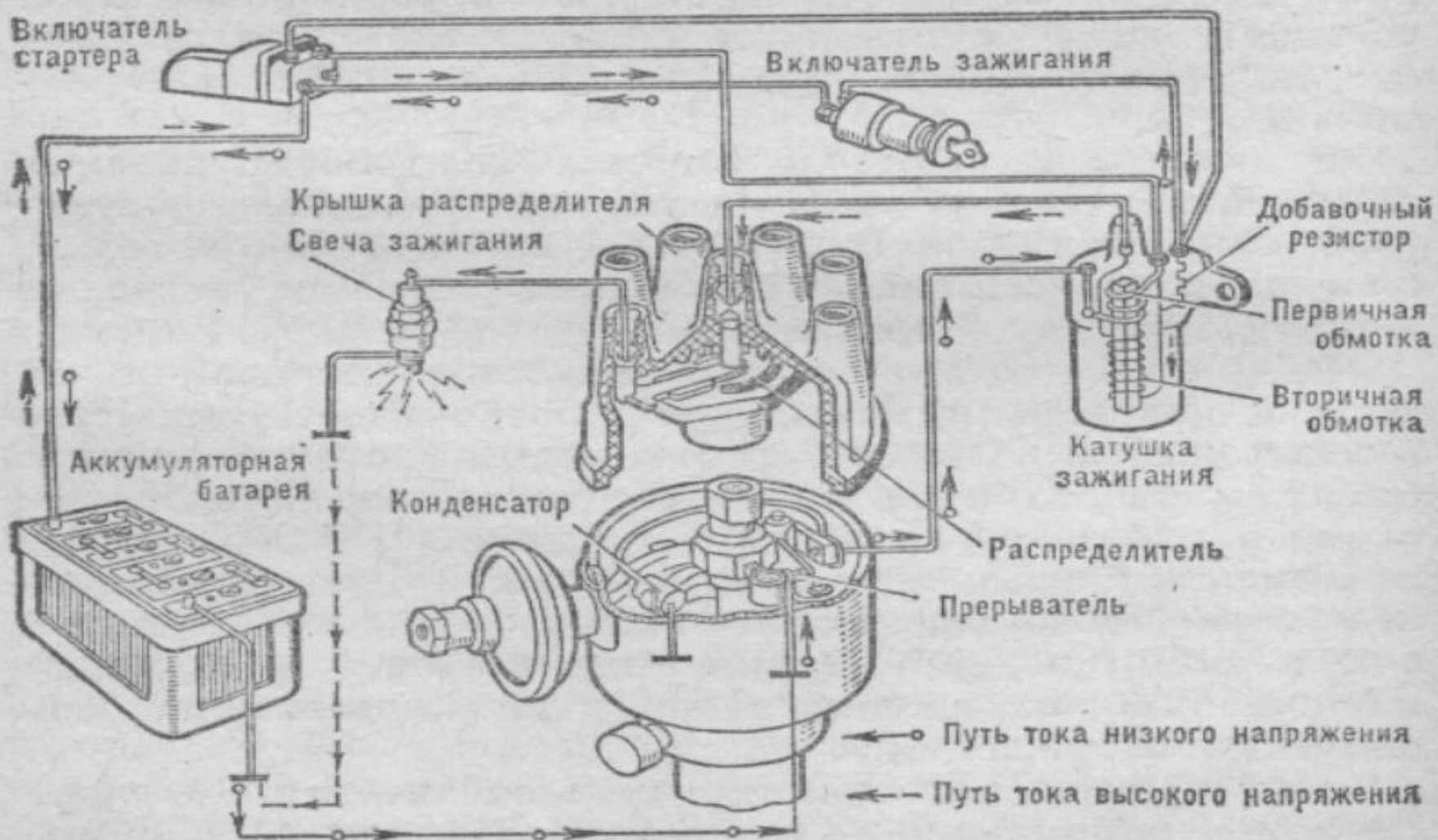
Рис. 23 Схема батарейного зажигания
