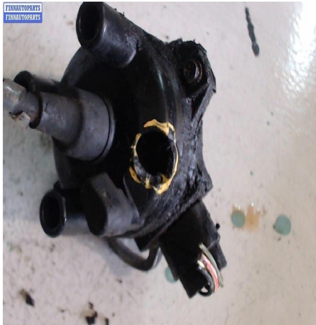
Распределитель зажигания (трамблёр) на Mazda 323 (BA) 1994-1998, 1994 г.в.
