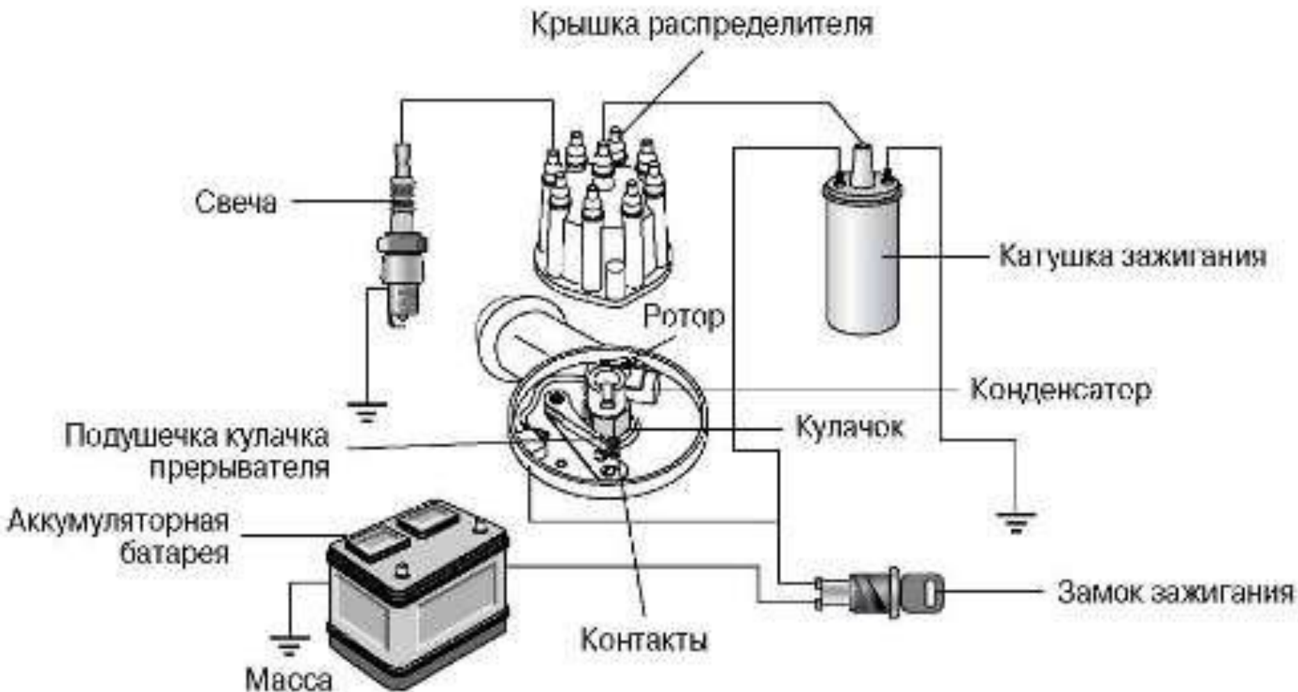
Рис. 5.8. Схема обычной неэлектронной системы зажигания
