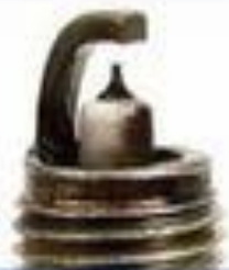
плохое уплотнение клапанов, цент. электрод засорен с одной стороны
