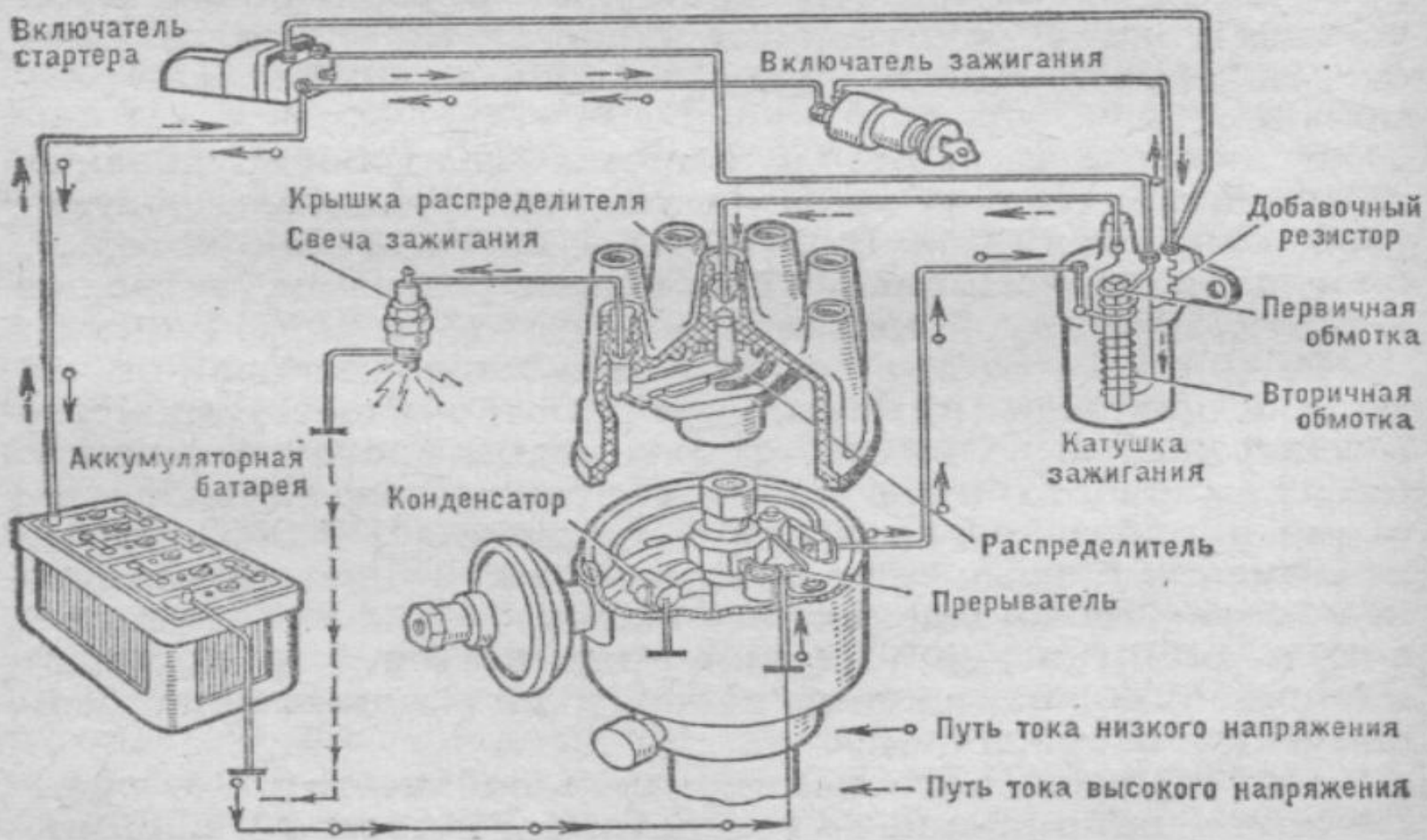
Рис. 23 Схема батарейного зажигания
